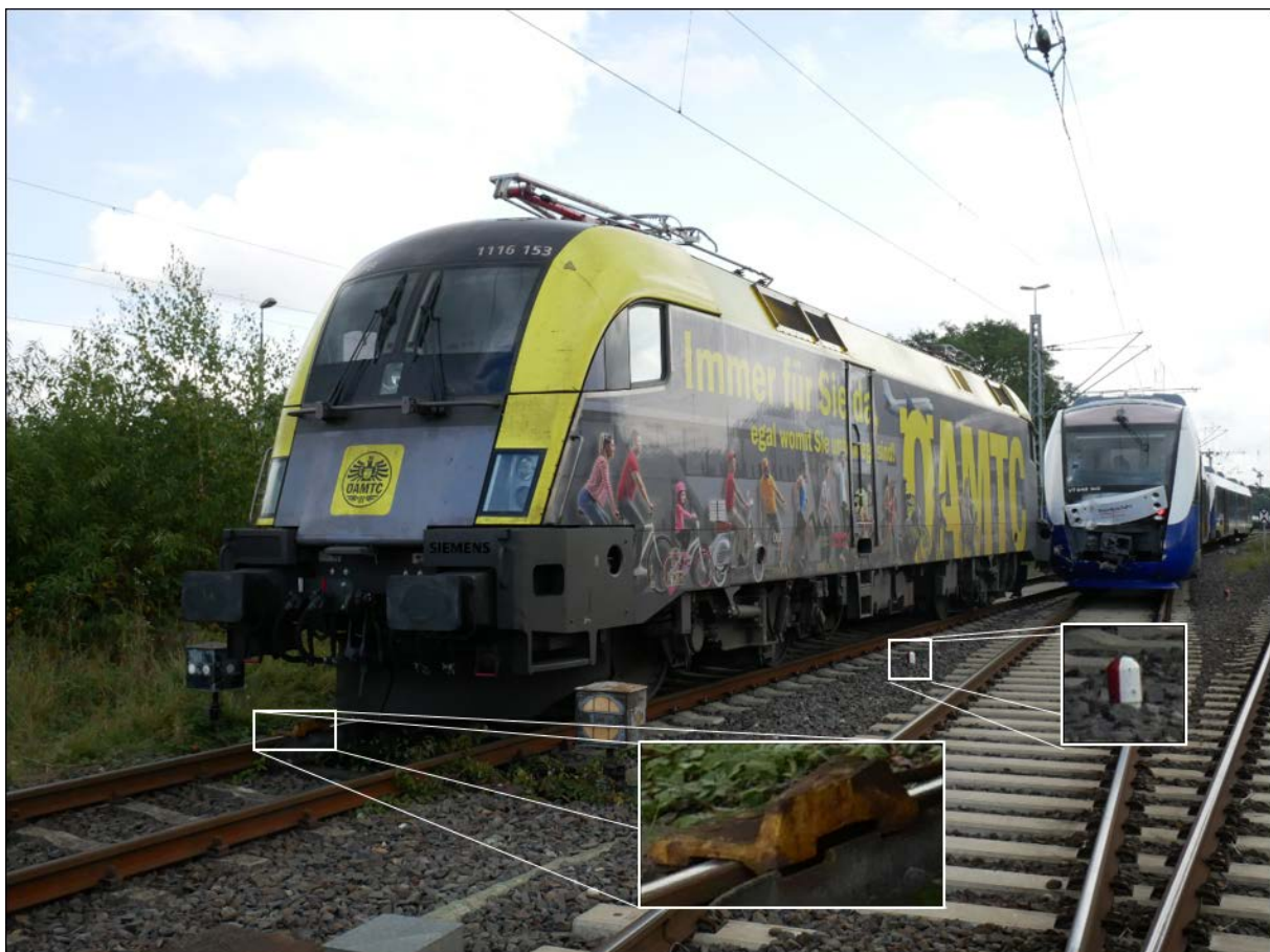
Abbildung 4: Position Tzf 153 in Gleis 21 sowie der Gleissperre „V“ und des Grenzzeichens der Weiche 41
