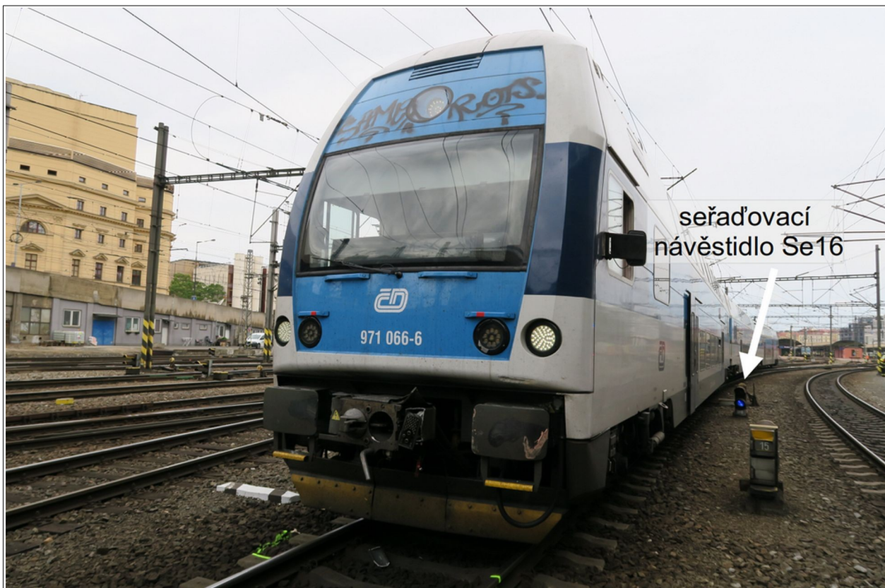
Obr. č. 4: Pohled na ŘDV 971.066-6 vlaku Os 9123 v konečném postavení po MU (předním čelem za úrovni seřadovacího návěstidla Se16 platného pro opačný směr jízdy) Zdroj: DI
