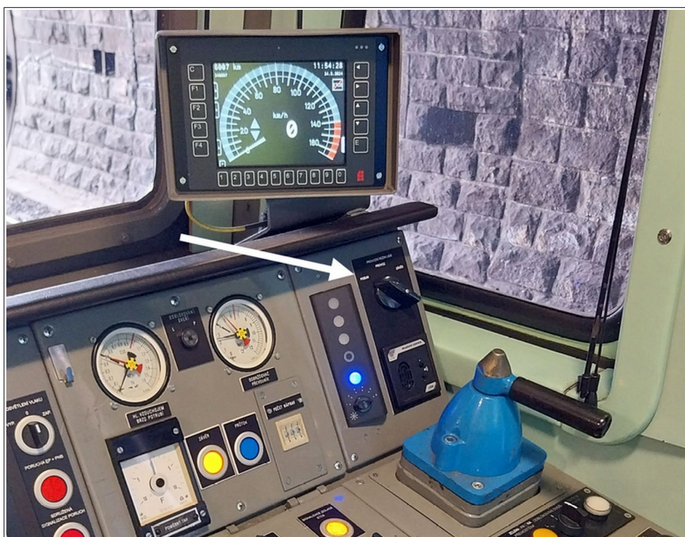
Obr. č. 9: Pohled mj. na přepínač provozních režimů ovládací jednotky mobilní části VZ LS06 v poloze „POSUN“ zadokumentovaný v době ohledání HDV 362.114-1. Zdroj: DI
