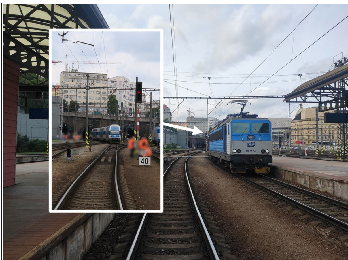
Obr. č. 6: Pohled na odjezdové návěstidlo S26 žst. Praha hl. n. z místa začátku její viditelnosti. Snímek ve výřezu dokumentuje návěst „Stůj“ téhož návěstidla návěstěnou v době jízdy vlaku Os 9123. Zdroj: DI
