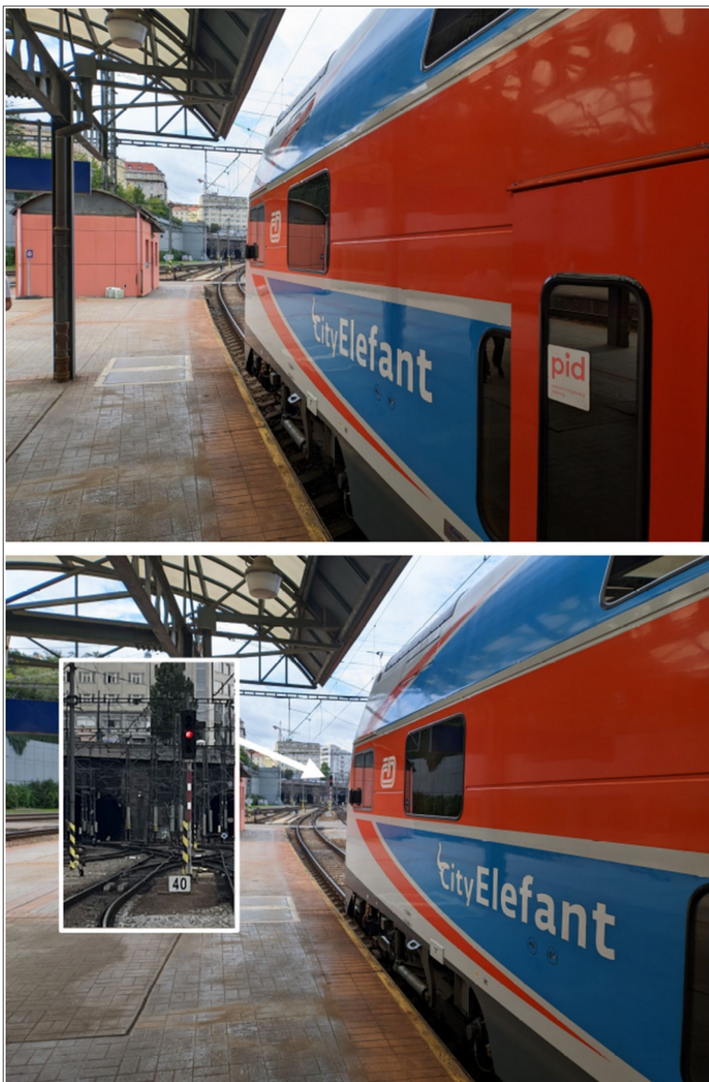
Obr. č. 7: Horní snímek dokládá skříní ŘDV rušenou viditelnost odjezdového návěstidla S26 z místa, kde stál vlakvedoucí vlaku Os 9123 před vznikem MU a odkud také dal návěst „Souhlas k odjezdu“. Dolní snímek dokládá nerušenou viditelnost odjezdového návěstidla S26 za podmínky odstoupení od vlaku o 30 cm směrem k podélné ose 6. nástupiště, kdy snímek ve výřezu dokumentuje jím návěstěnou návěst „Stůj“.
