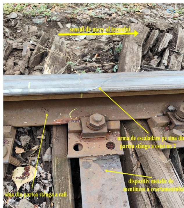
Foto nr.17 - punctul de reper „C” - escaladare a ciupercii şinei a rotii 3L a osiei nr.2
