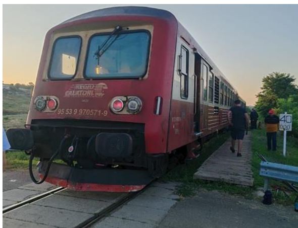
Foto nr.2 – Automotorului AMX 571 deraiat
