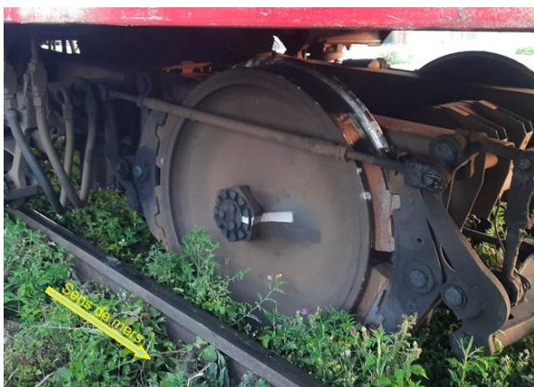
Foto nr.3 – Osia nr.6 deraiată
