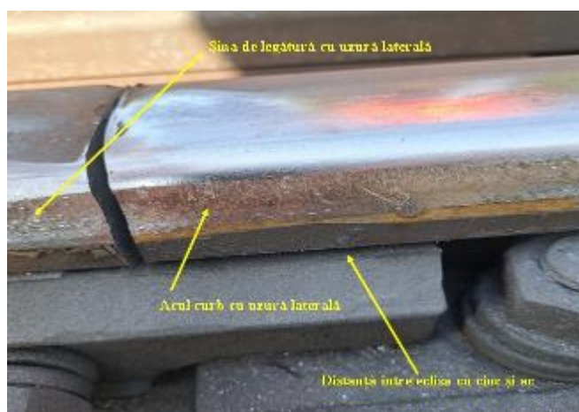
Foto nr.25 – Urmă de uzură laterală a șinei
