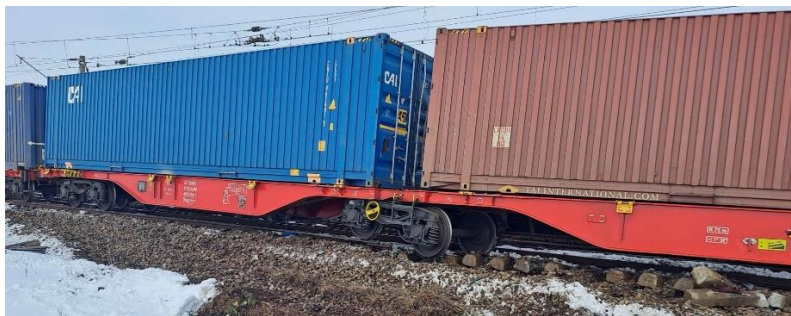
Foto nr.8 – Vagonul de marfă nr.3375952004-3 cu primele 2 boghiuri deraiate
