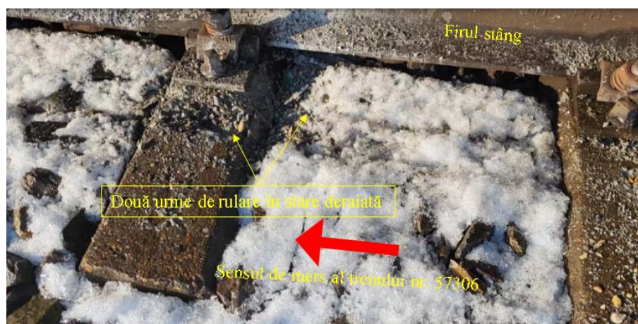
Foto nr.17 – Două urme de rulare în stare deraiată pe aliniamentul dintre schimbătoarele de cale nr.10 și nr.8
