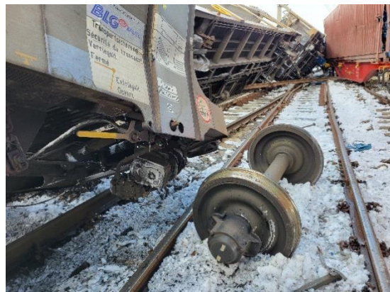
Foto nr.6 – Vagonul de marfă nr.23884371951-5 cu primul semi-vagon avariât având o osie sărită
