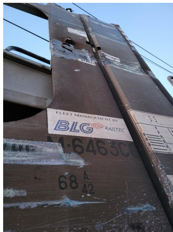
Foto nr.5 – Lovituri identificate pe partea laterală a vagonului de marfă nr.23884371557-0
