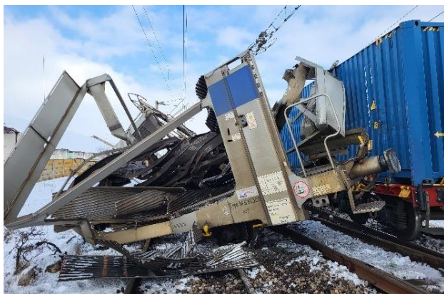
Foto nr.6 – Vagonul de marfă nr.23884371951-5 cu primul semi-vagon avariât având o osie sărită
