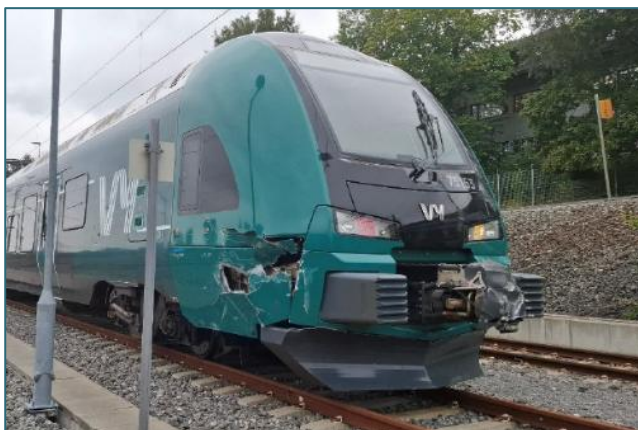
Figur 9: Skader i fronten på sett 75-53. Foto: Stadler Service Norway AS
