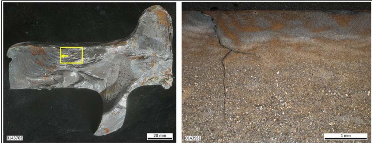
Abbildung 15: Mikrolängsschliff im Bruchstück A mit Anriss 11
