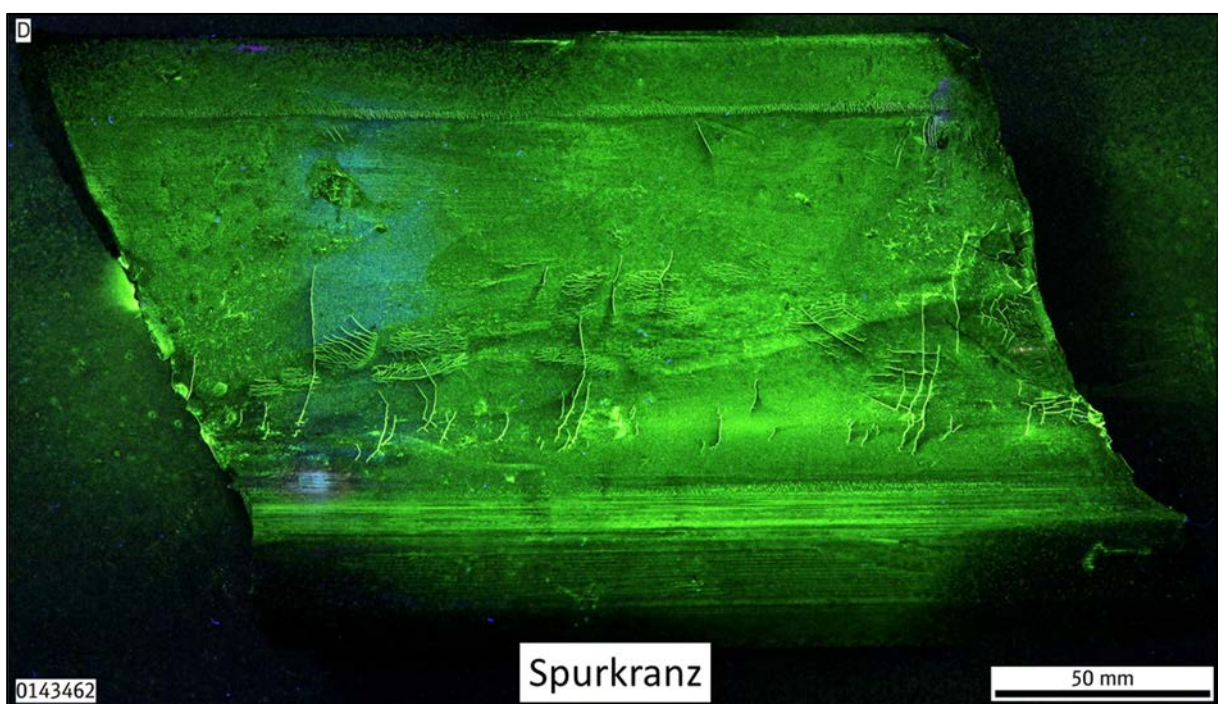
Abbildung 12: Bruchstück D mit regellos orientierten Anzeigen 9
