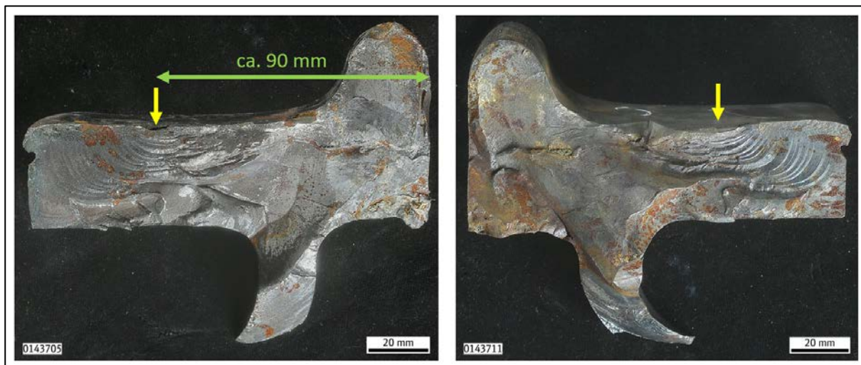
Abbildung 10: Bruchflächen zwischen Bruchstück A und B 8
