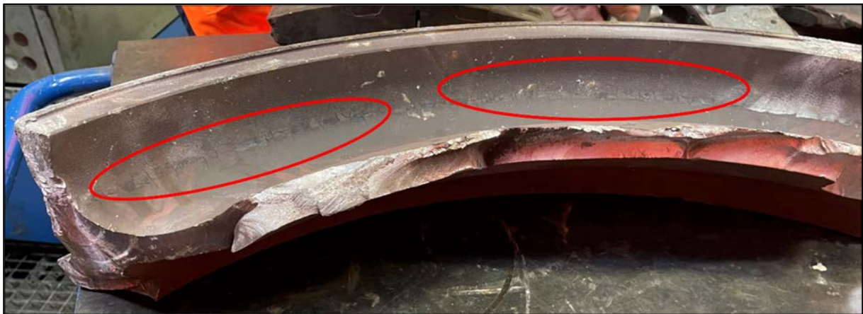
Abbildung 13: Farbabbrand am Übergang zwischen Radkranz und Radsteg
