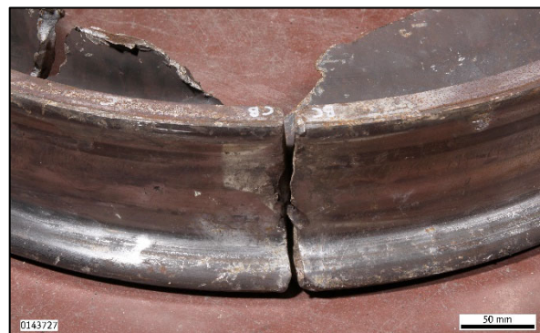
Abbildung 10: Bruchstelle zwischen B und C 6
