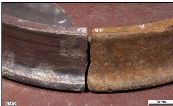
Abbildung 9: Bruchstelle zwischen A und B 6
