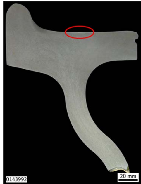
Abbildung 21: Makrogefüge auf der B - Seite 12
