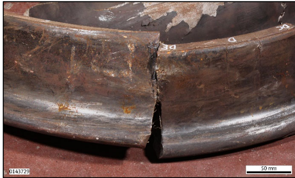
Abbildung 12: Bruchstelle zwischen D und E 7
