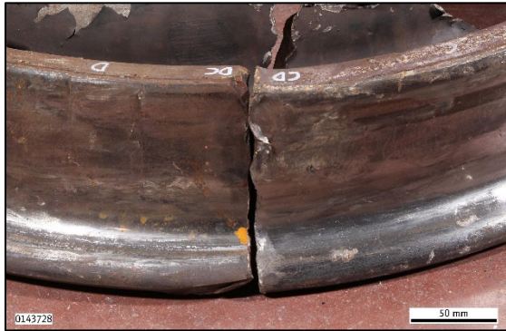
Abbildung 11: Bruchstelle zwischen C und D 7
