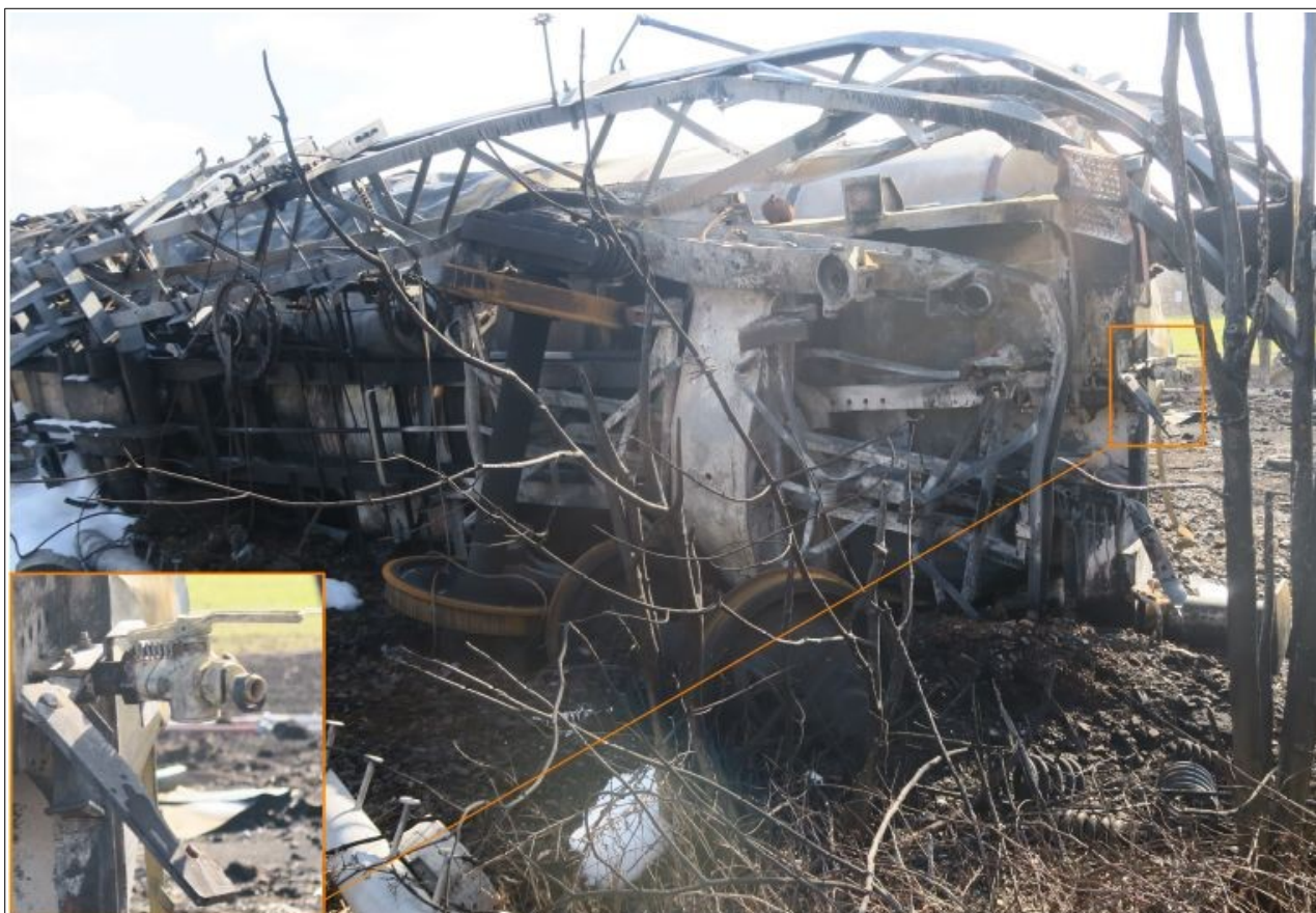
Obr. č. 6: Pohled na přední čelo a spodek 1. TDV za HDV vlaku Pn 52690 v konečném postavení po MU, kdy snímek ve výřezu dokumentuje detailní pohled na otevřený spojkový kohout hlavního potrubí.
