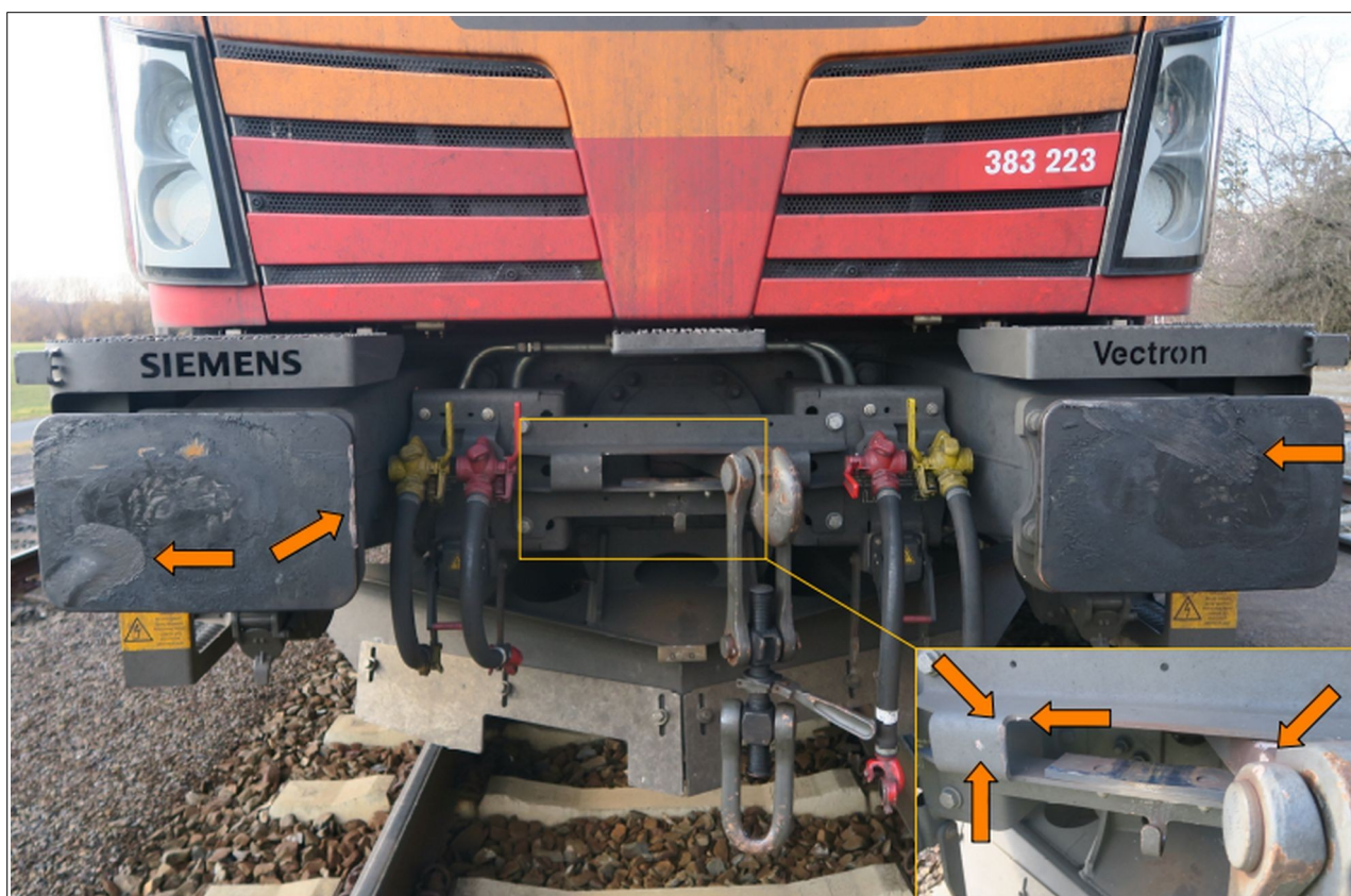
Obr. č. 4: Pohled na táhlové a nárazecí ústrojí na zadním čele HDV 383.223-5, kdy oranžové šipky ukazují na stopy na talířích obou nárazníků. Snímek ve výřezu dokumentuje stopy po naražení dřívku táhlového háku a závěsnice šroubovky na straně svorníku do levé a levé horní strany vodička táhla táhlového ústrojí v konečném postavení HDV po MU.
