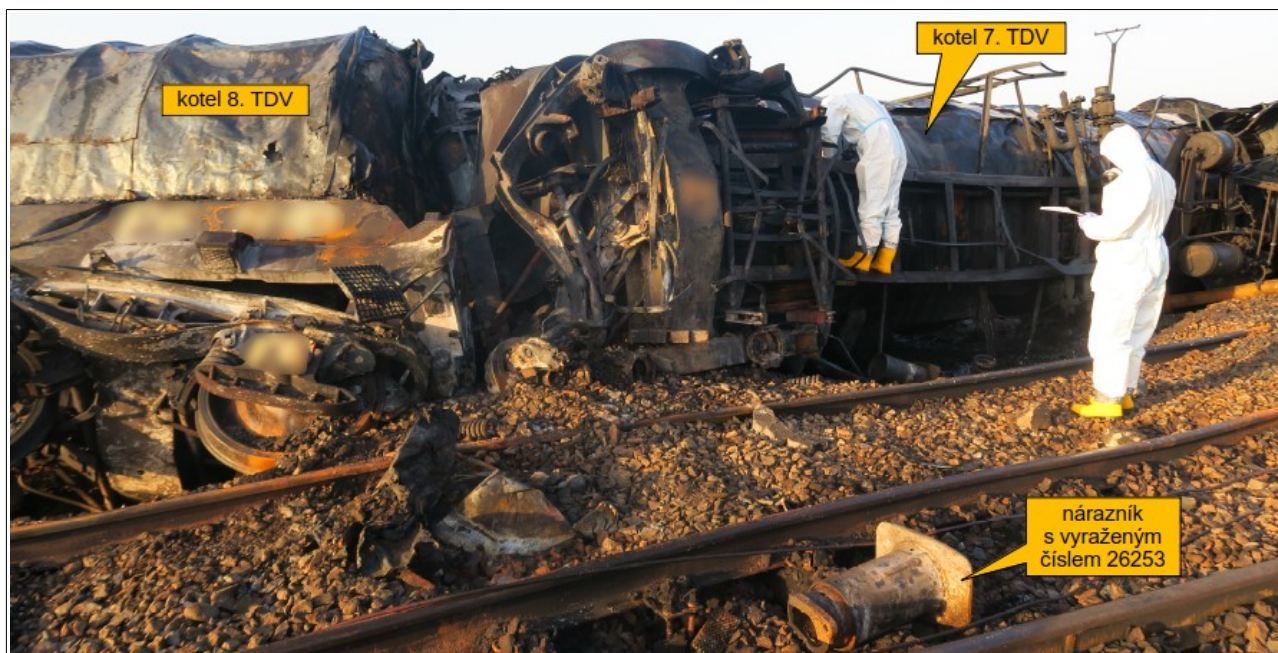
Obr. č. 10: Pohled na poškozené 7. a 8. TDV vlaku Pn 52690 a na poškozený železniční svršek při ohledání inspektory DI a příslušníky PČR
