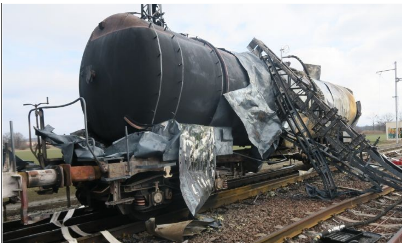
Obr. č. 14: Pohled na zadním podvozkem vykolejené a poškozené 15. TDV. Snímek byl pořízen po odtlačení 16. a 17. TDV do bezpečné vzdálenosti za účelem zabránění vzniku dalších škod.
