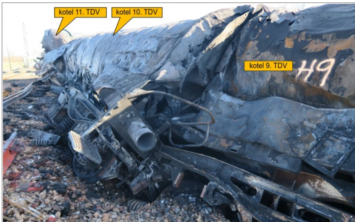
Obr. č. 11: Pohled na čelo 10. TDV vnořené do zadního čela 9. TDV
