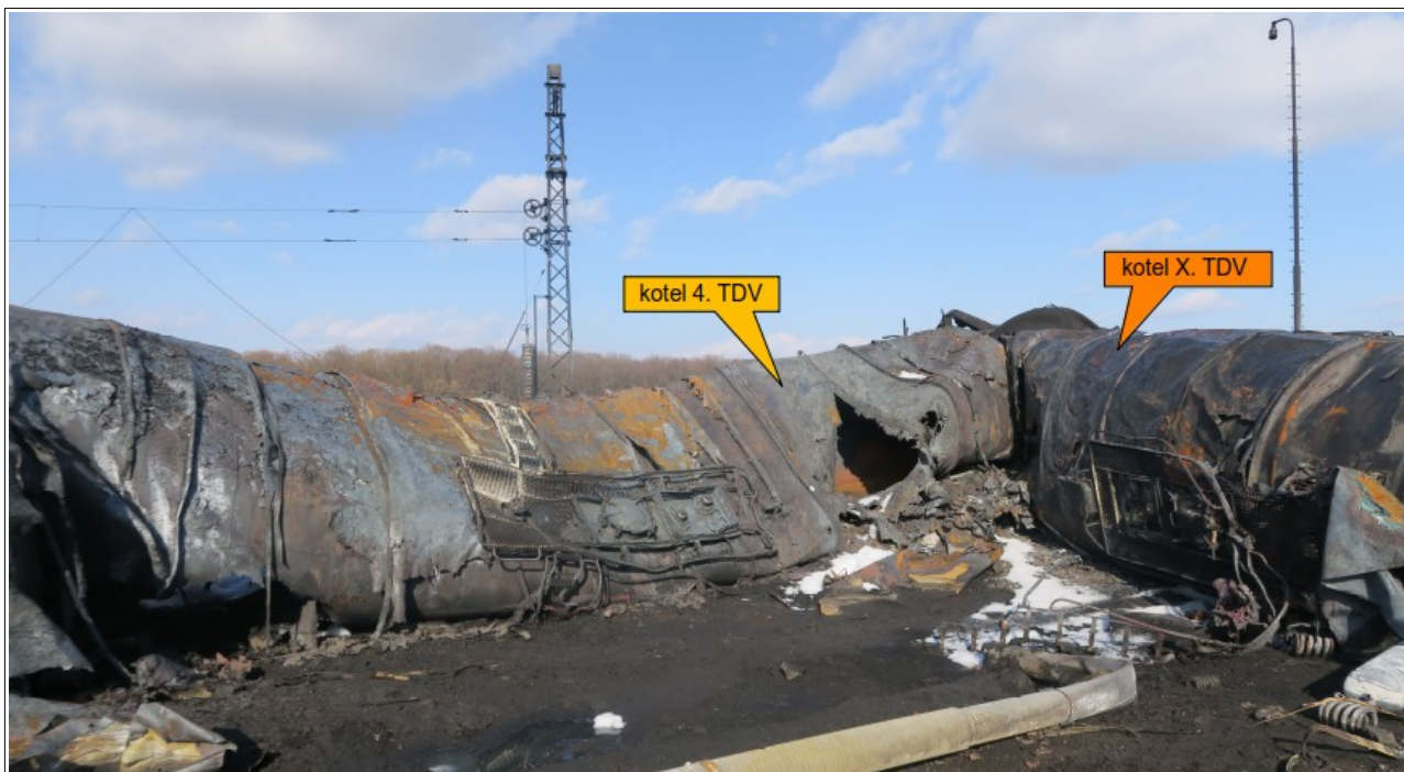
Obr. č. 8: Pohled na roztržený kotel 4. TDV a poškozený kotel X. TDV vlaku Pn 52690
