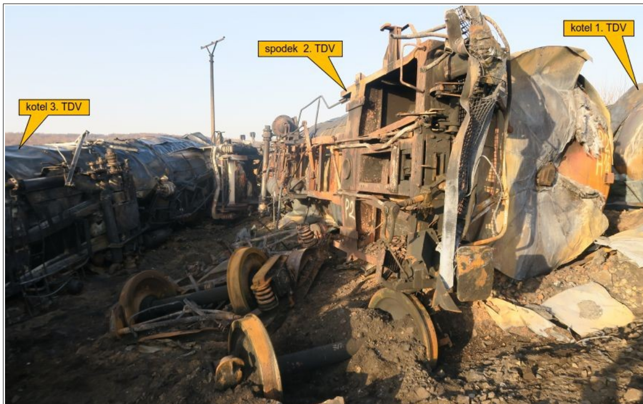
Obr č. 7: Pohled na spodek destruovaného 2. a 3. TDV vlaku Pn 52690 v konečném postavení po MU
