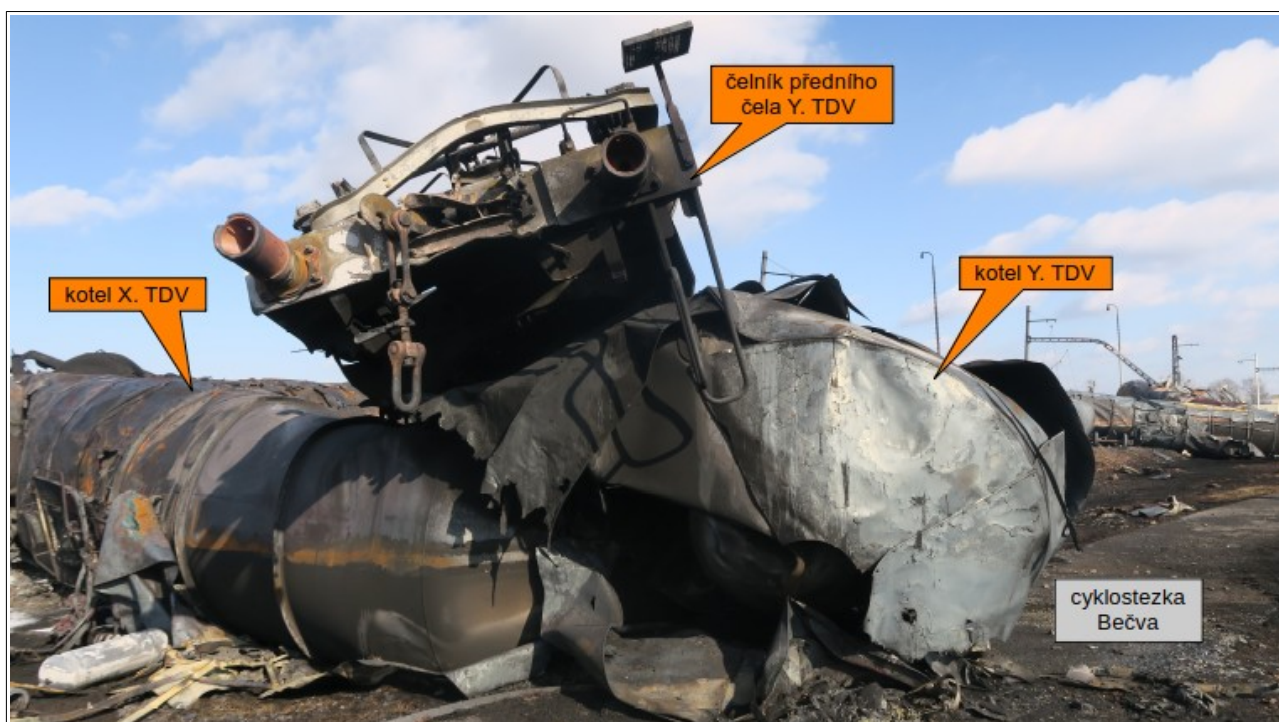
Obr. č. 9: Pohled od cyklostezky Bečva na poškozený kotel X. TDV a destruované Y. TDV vlaku Pn 52690
