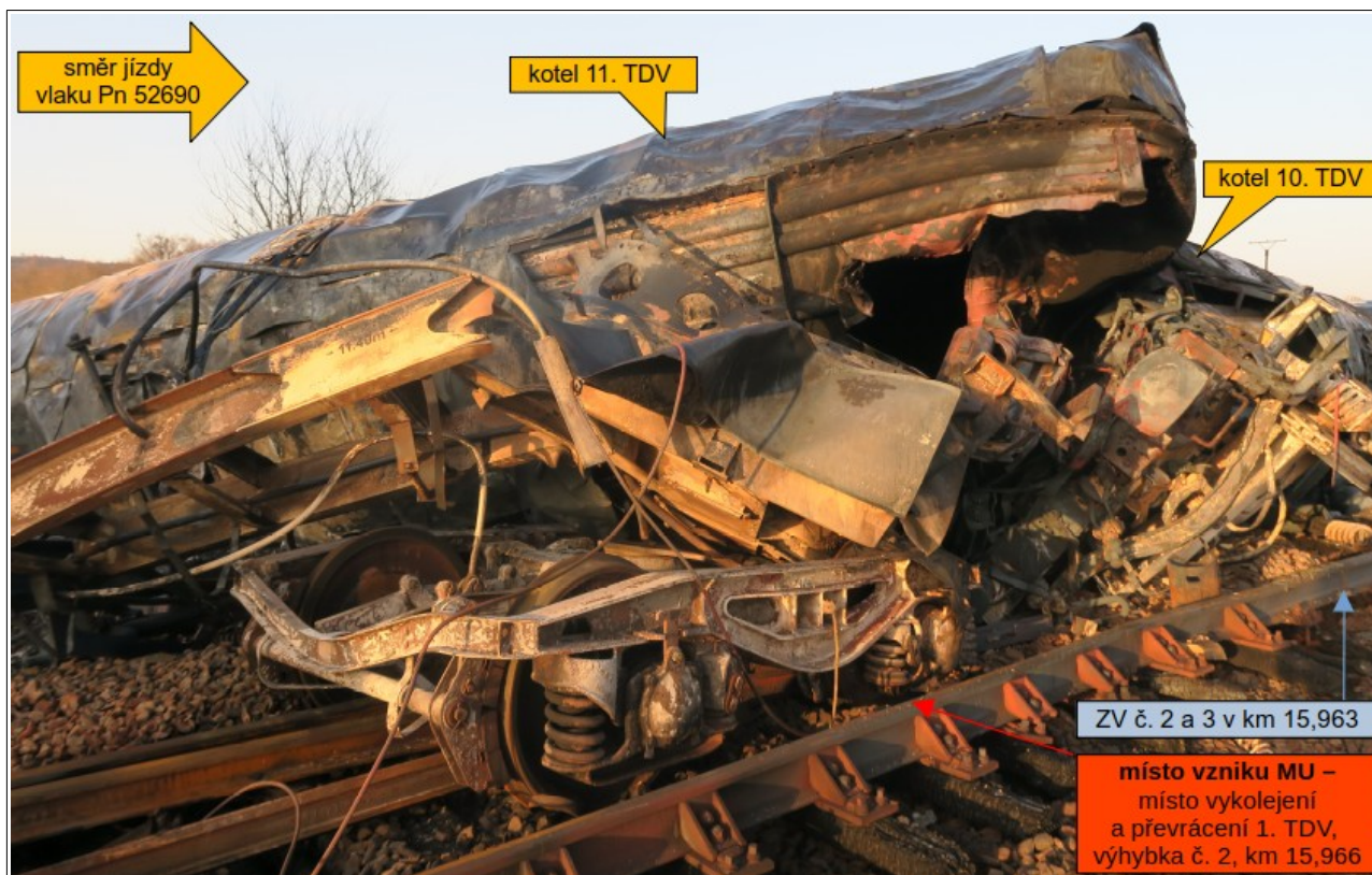
Obr. č. 2: Pohled na místo vzniku MU v km 15,966, poškozený železniční svršek a destruovaná TDPV
