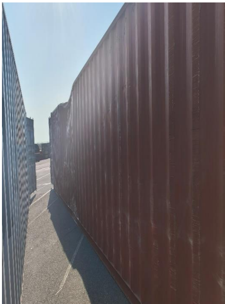
Foto nr.12 - Perete container partea dreaptă avariat
