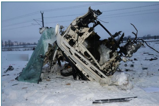
Figur 6: Førerhuset etter sammenstøtet. Foto: SHK
