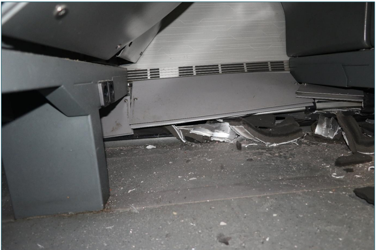
Figur 13: Deler fra hengeren har kommet gjennom karosseriet der passasjerer befant seg. Foto: SHK
