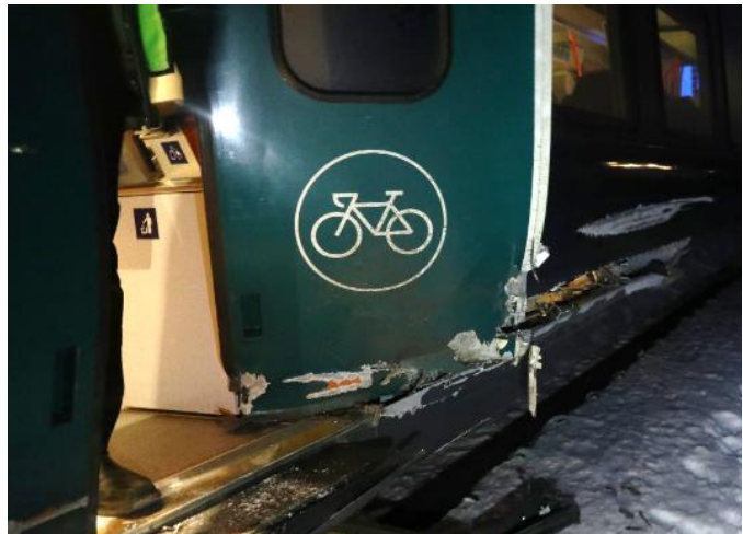
Figur 10: Skadene der tilhengeren slo hull på vognsiden av sett 75-11. Foto: SHK
