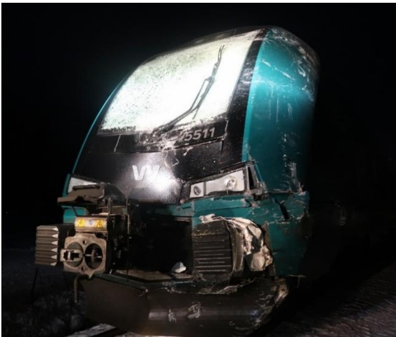
Figur 9: Skader på fronten av sett 75-11. Foto: SHK
