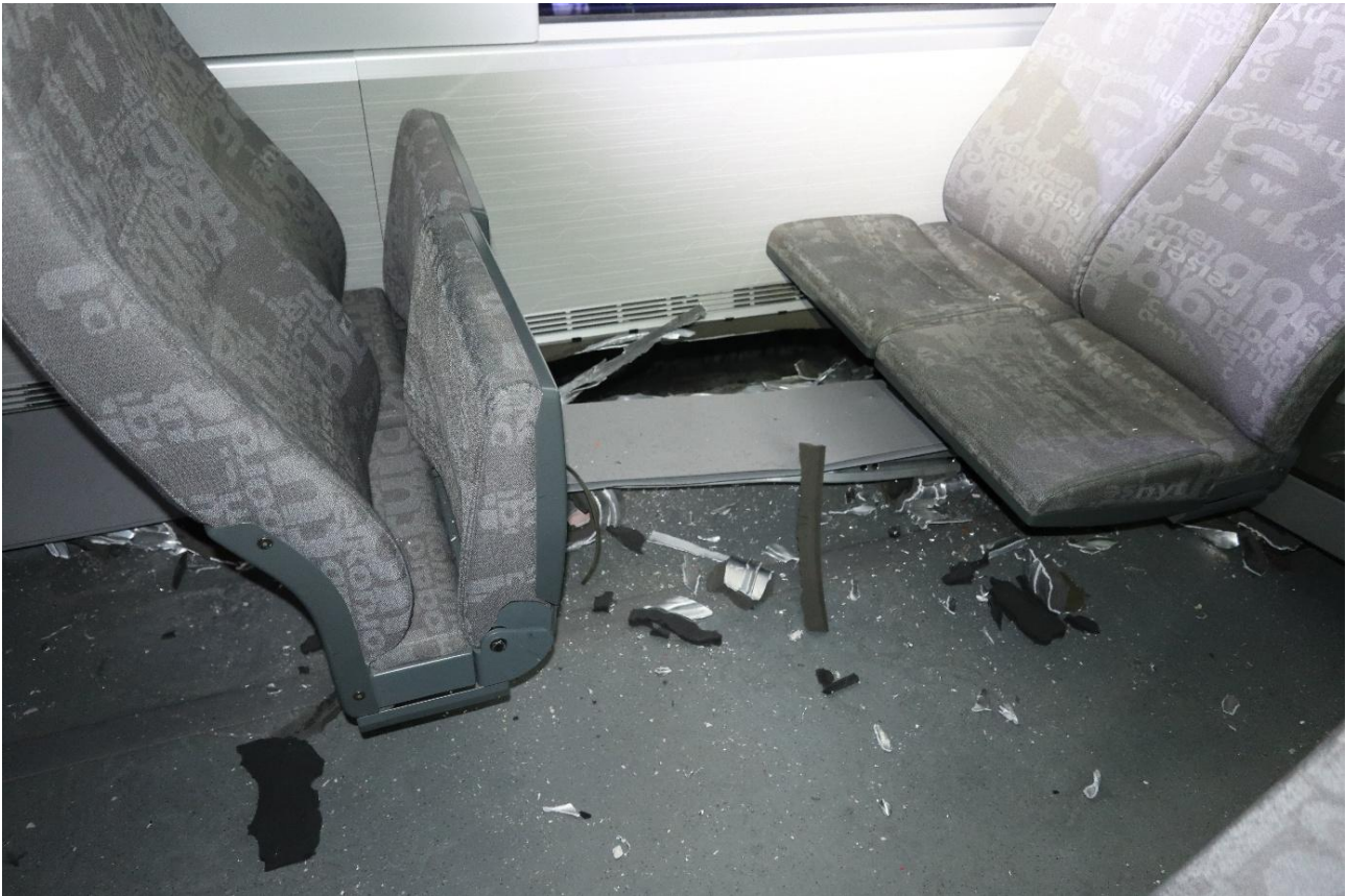
Figur 14: Deler fra hengeren laget flenge i karosseriet der passasjerer befant seg. Foto: SHK
