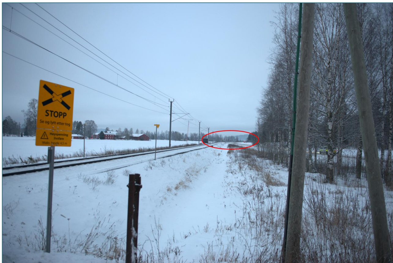
Figur 22: Siktlinje i den retningen toget kom fra. Rød markering viser hvor jernbanesporet og veien tilsynelatende går sammen innenfor et lite område av sikten. Foto: SHK
