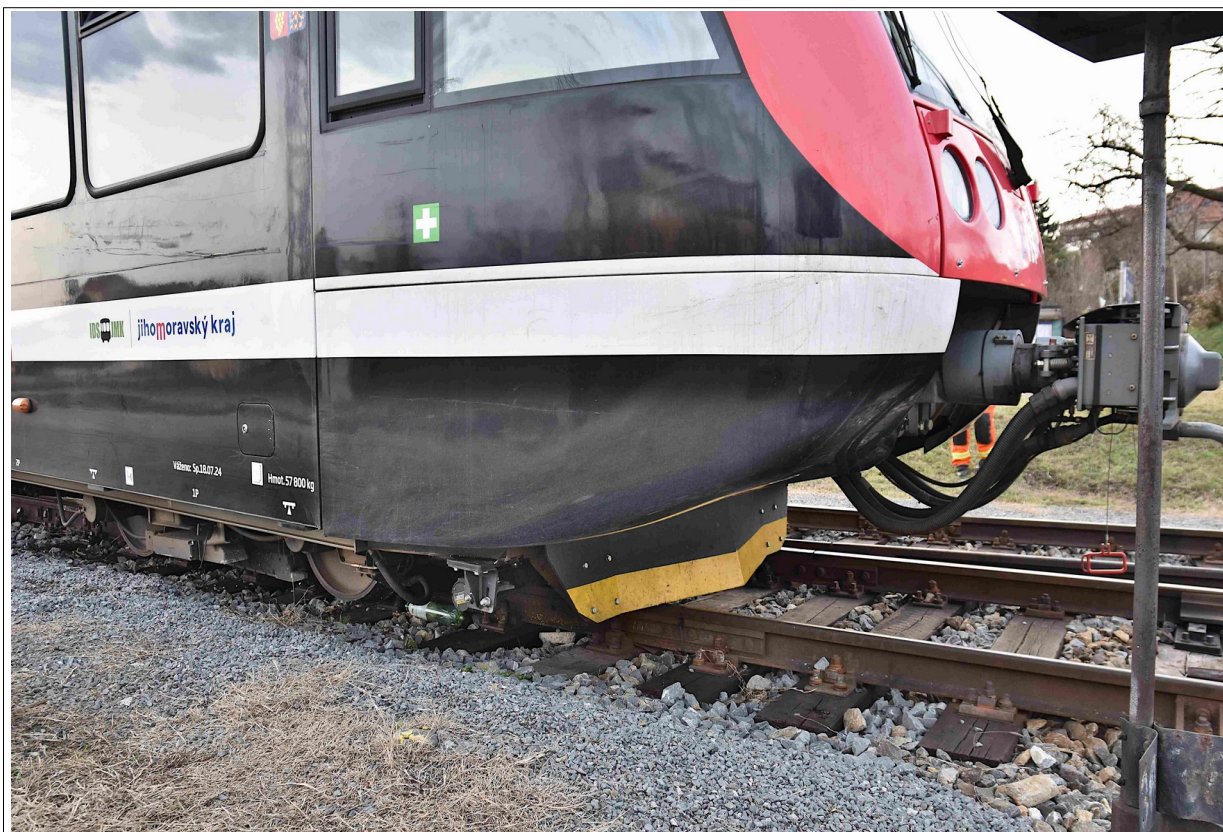
Obr. č. 7: Pohled na vykolejený první podvozek ve směru jízdy vlaku Os 4521
