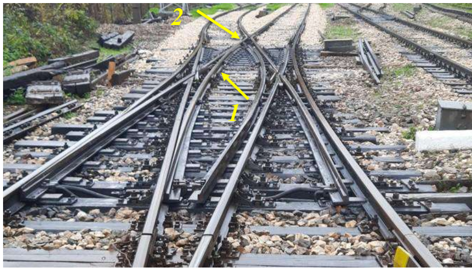
Фиг. 3.2. Поз. 1 – място на счупване на езика; Поз. 2 – точка на дерайлиране на локомотива.
