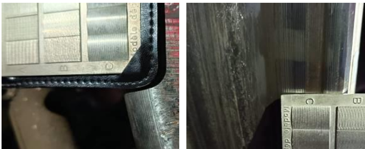
Foto nr.5 și 6 – Rugozitatea profilului de rulare la locomotiva LEMA 014
