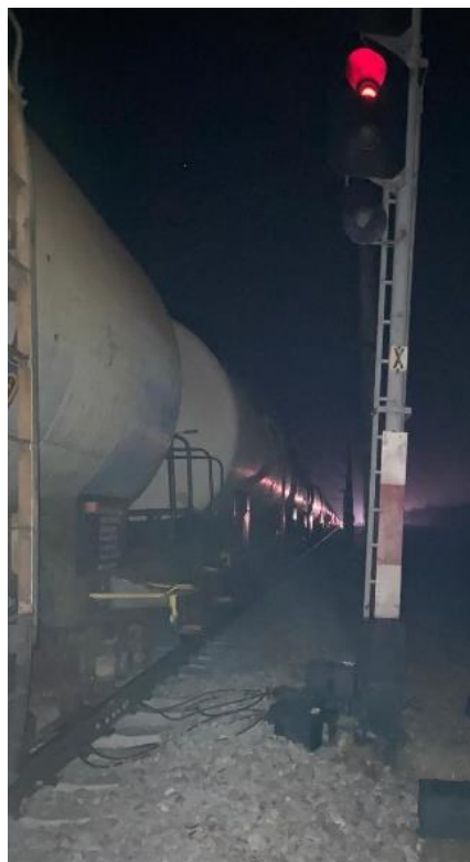
Figura nr. 2 – semnalul luminos de intrare X la data producerii accidentului afișa spre tren o unitate luminoasă de culoare roșie cu indicația „OPREȘTE fără a depăși semnalul!”
