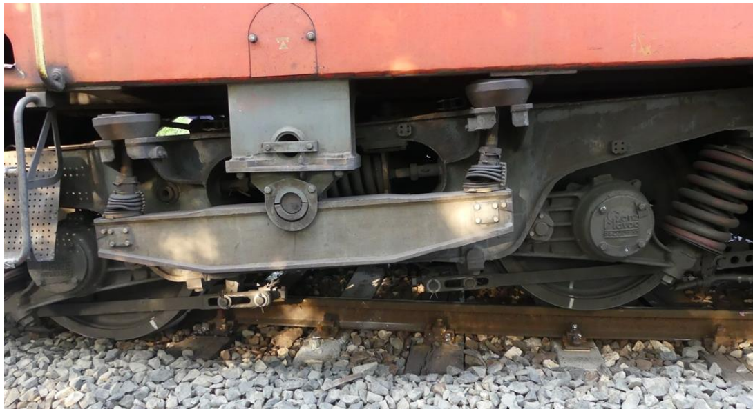
6. ábra: a kisiklott mozdony forgóváz-bekötése
