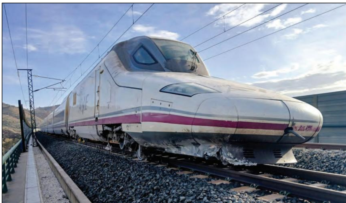
Figura 4 Tren 02123 descarrilado detenido tras recorrer 1.563 m (Fuente: ADIF)
