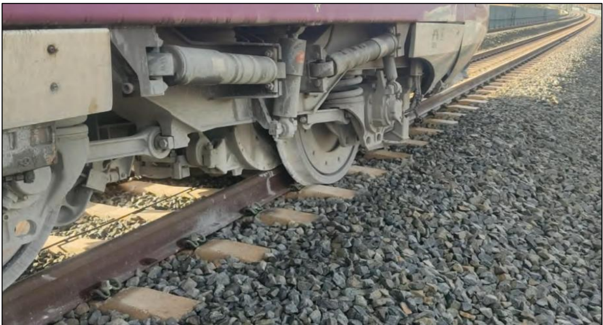
Figura 3 Primer eje del primer bogie de la cabeza tractora descarrilado hacia el exterior de la vía (Fuente ADIF)
