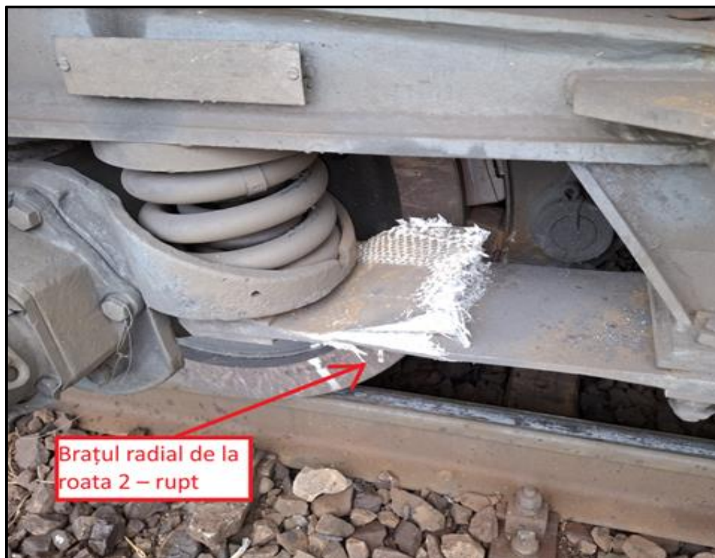
Foto nr.6 - Braț radial de la roata 2 – rupt
