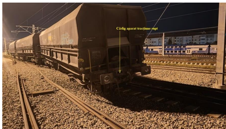
Foto nr.3 - Cârlig aparat de tracțiune rupt
