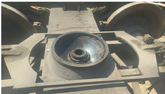
Foto nr.7 – Crapodina inferioară la boghiul deraiat corespunzător roților 5÷8
