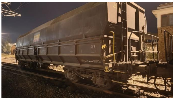
Foto nr.1 - Primul boghiu (roțile 5÷8) deraiat în sensul de mers pe schimbătorul de cale nr.74
