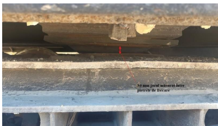
Foto nr.8 – Jocul între pietrele de frecare măsurat pe partea dreaptă sens de deplasare la boghiul cu roțile 1÷4
