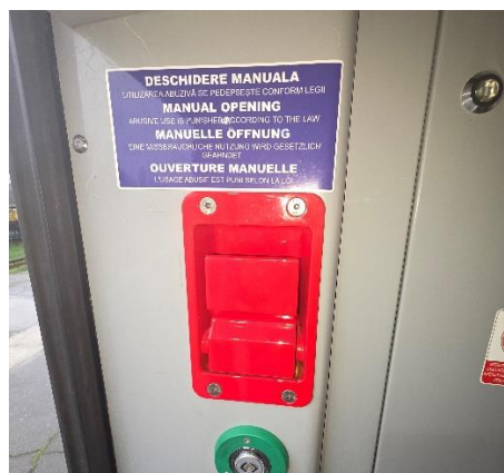
Foto nr.12 – dispozitiv de ieșire de urgență
