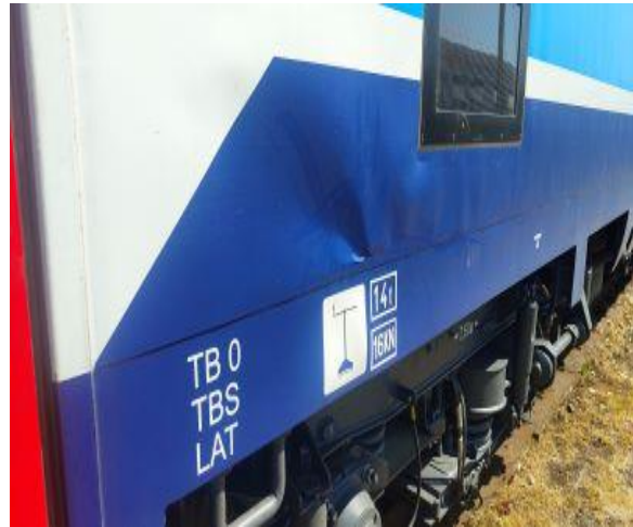
Foto nr.9 – Perete lateral deformat
