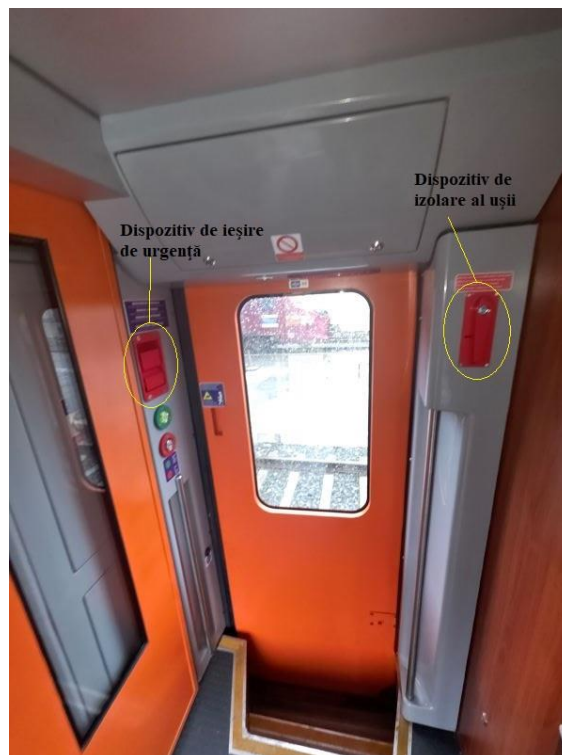
Foto nr.10 – Sistem deschidere de urgență
