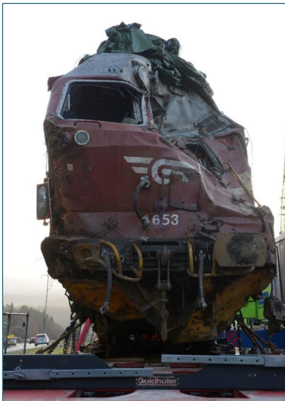
Figur 22: Skader i front av Di4.653. Foto: SHK
