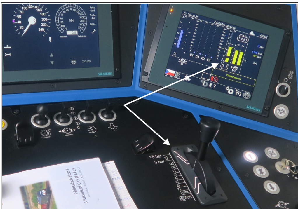
Obr. č. 5: Pohled mj. na ovládací prvek (páku brzdiče strojvedoucího) a technický a diagnostický displej v kabině strojvedoucího 1 zadokumentované v době ohledání HDV 1293.114-5. Zdroj: DI
