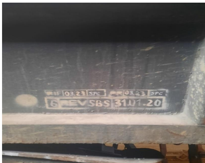
Foto nr.2 – cartuș de mentenanță al vagonului nr. 81536652446-1 cu revizia periodică și reviziile intermediare (RP, RRu, RIF) ;
