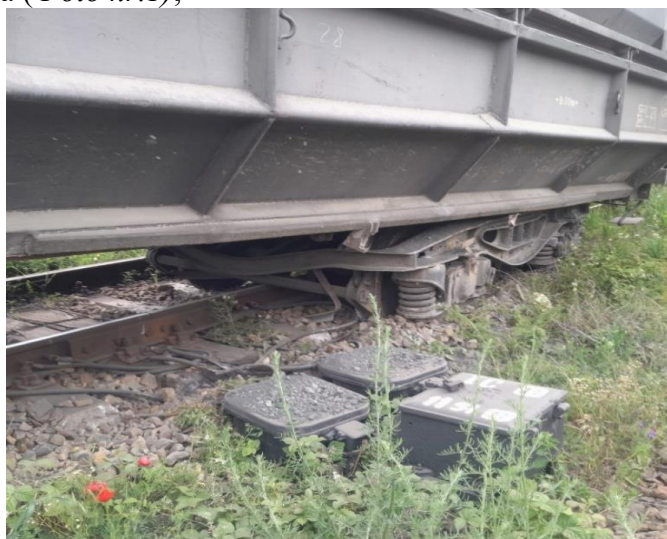
Foto nr.1 – boghiul deraiat ;
