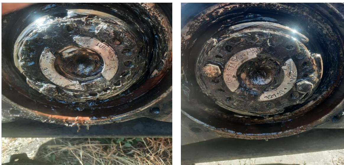
Foto nr.9 și nr.10. – marcajul pe ambele fusuri de osie ale roților 7-8;
