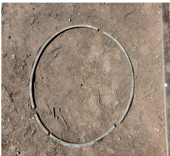
Foto nr.8 - inelul de fixare rupt în 4 (patru) puncte, fără urme de polizare;
