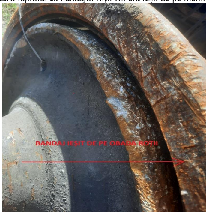
Foto nr.11 – bandajul ieșit de pe membrană al roții nr.8;
