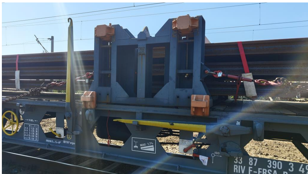
Imaginea nr.14 – jugul central plasat pe al 3-lea vagon din cuplul de 6 vagoane în sens de mers
