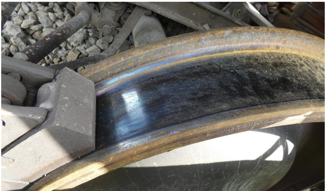
5. ábra: elszíneződött kerék a 470-4 psz. kocsi második forgóvázában (a kép alapján sejthetővel ellentétben a futófelület nem sérült, nem keletkezett a keréken külső ál-nyomkarima)
