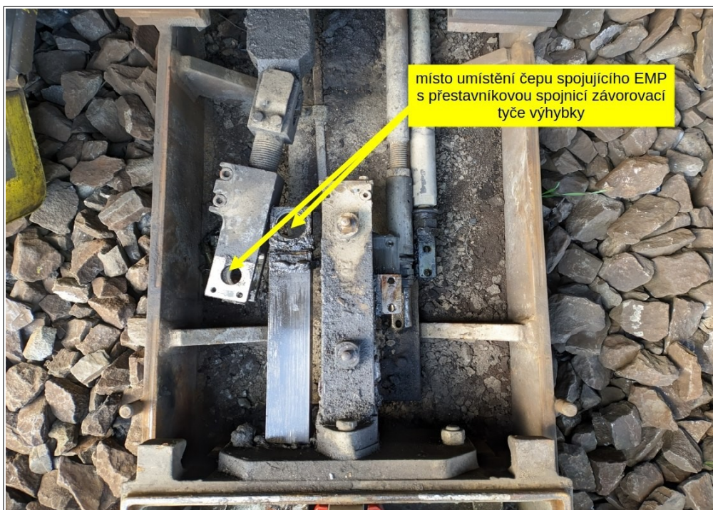
Obr. č. 6: Pohled na mechanické odpojení EMP 103a1 od přestavňovací spojnicí závorovací tyče křižovatkové výhybky č. 103ab Zdroj: DI
