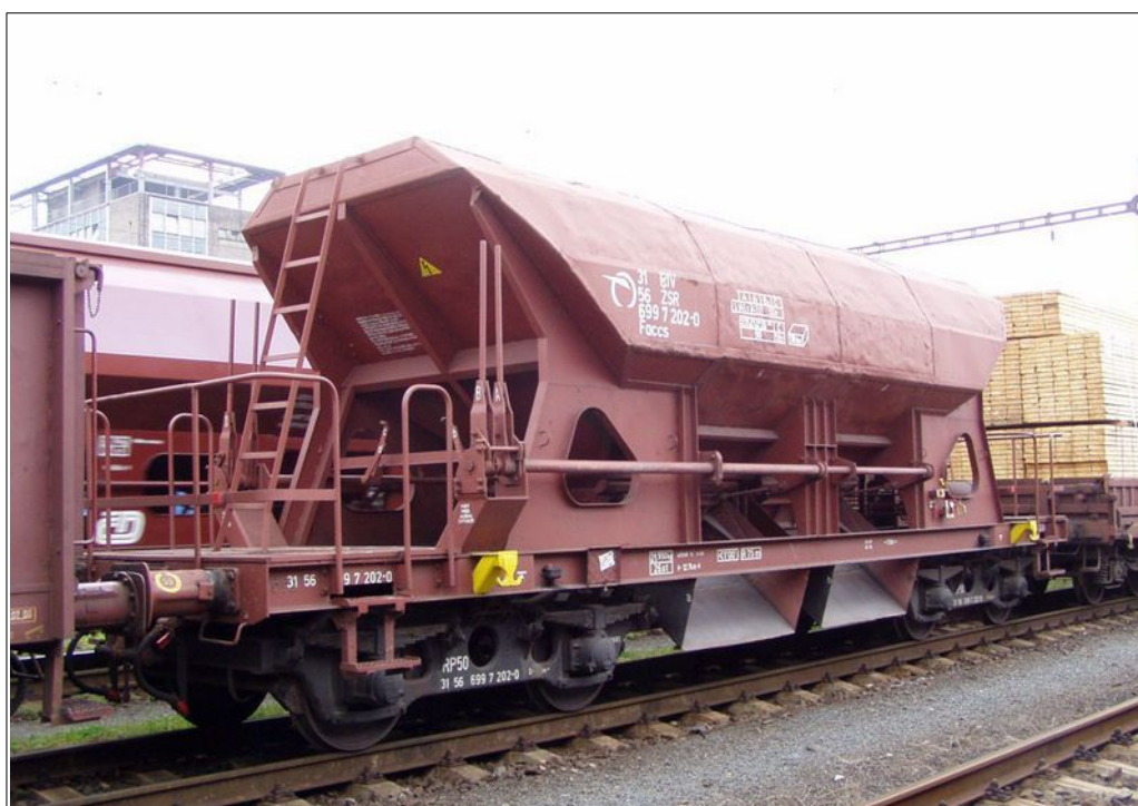
Obr. č. 26: Vůz Faccs, typ 9-407.0, s ložným objemem 38 m 3 Zdroj: www.parostroj.net
