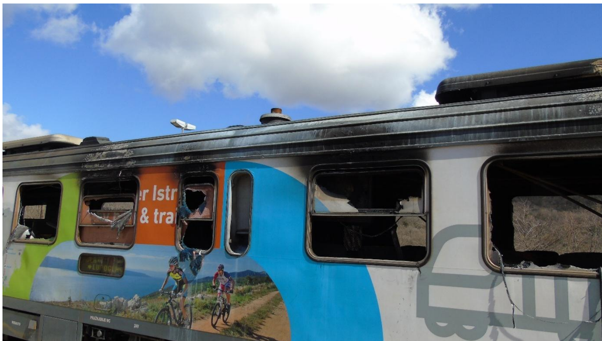
Slika 6. Sredina opožarenog dizel motornog vlaka serije 7122 (Izvor slike: AIN)
