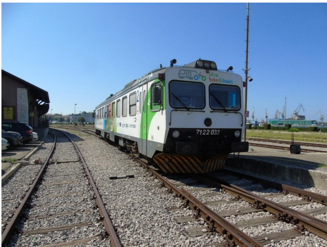
Slika 2. – Dizel motorni vlak serije 7122 (Izvor slike: AIN)
