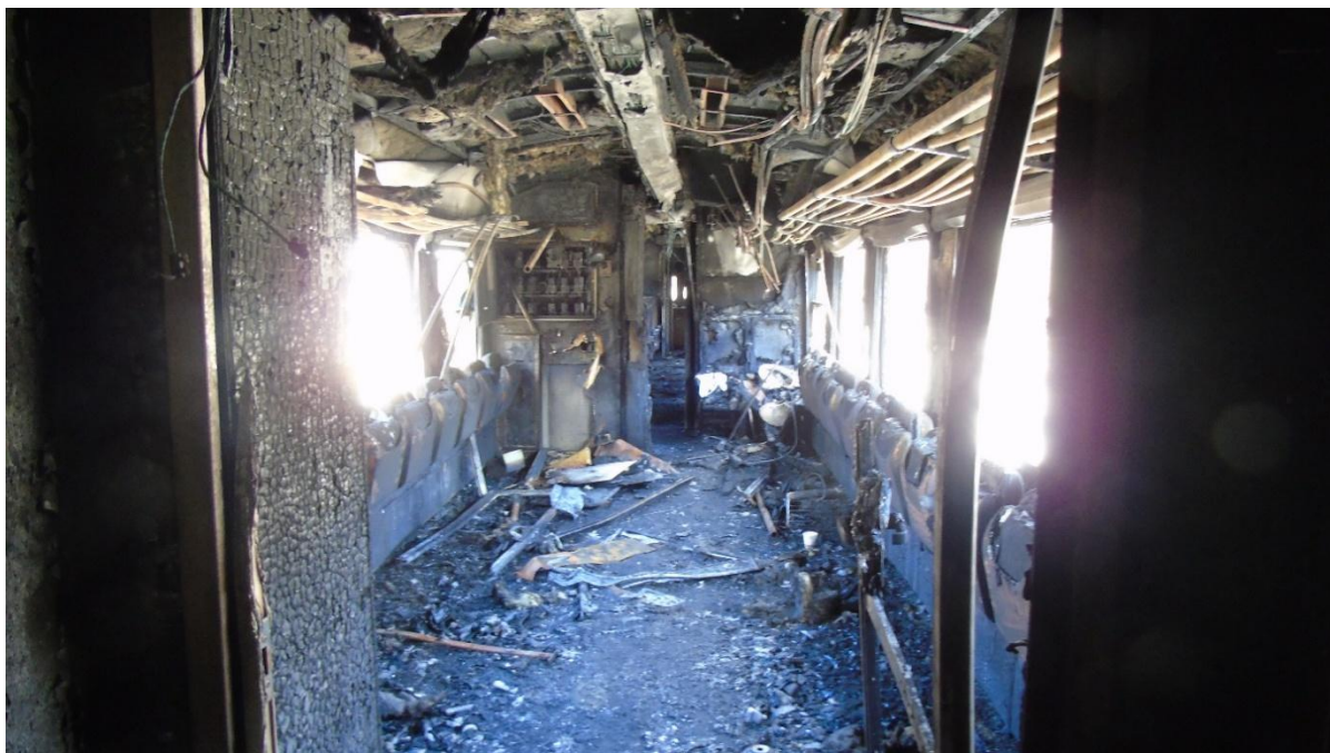
Slika 8. Opožareni putnički prostor vlaka broj 7122 033 (Izvor slike: AIN)
