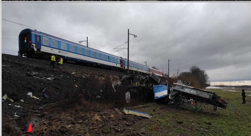
Obr. č. 19, 20 Následkem střetnutí zničená vrtací souprava Soilmec SR-65 nacházející se v konečném poloze po MU pod patou svahu zemního tělesa náspu vně TK č. 2. Zdroj: DI
