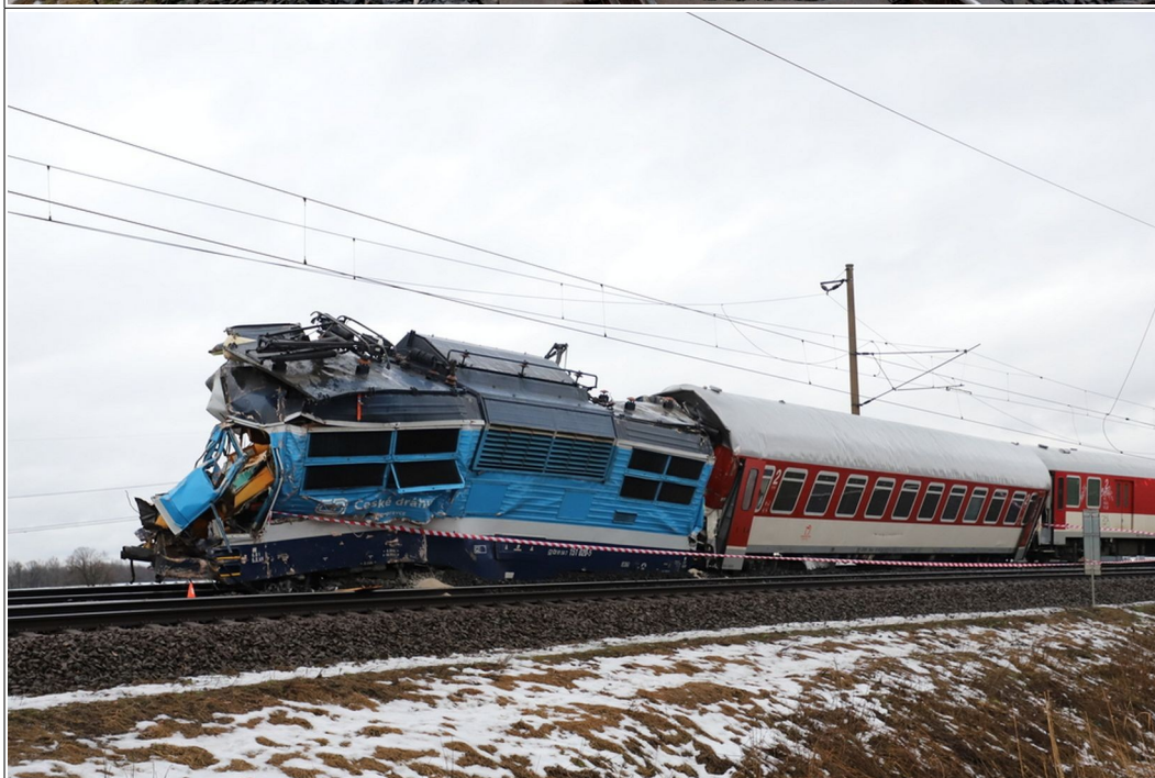
Obr. č. 9, 10 Snímky dokumentující vykolejené HDV a 1. TDV vlaku Ex 546 v konečném postavení po MU. Fotografie mj. dokládají totální destrukci lokomotivy 151.020-5.
