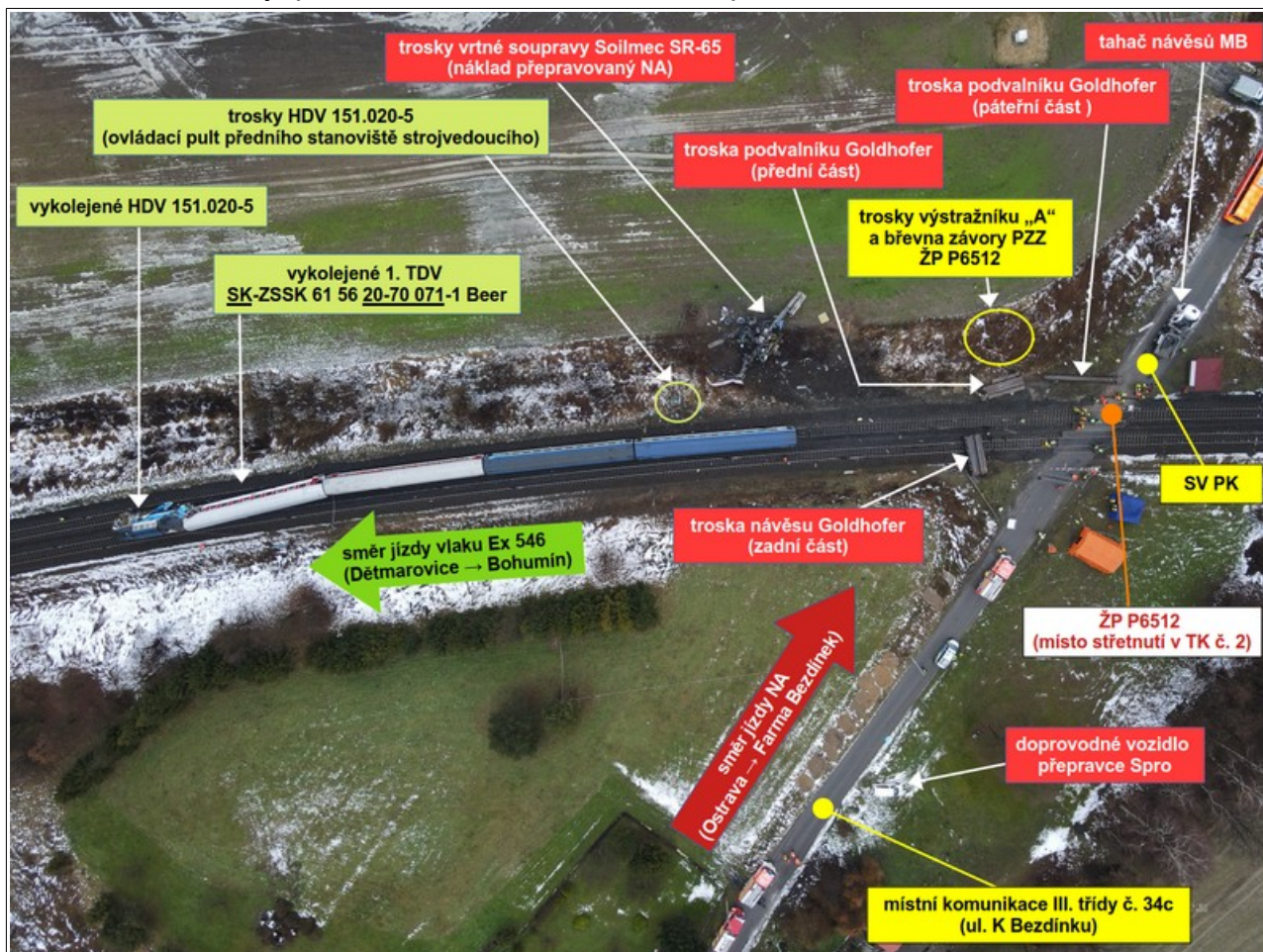
Obr. č. 2 Situační schéma místa MU zobrazující polohu a stav DV, NA a vrtací soupravy Soilmec SR-65 v konečném postavení po MU.
