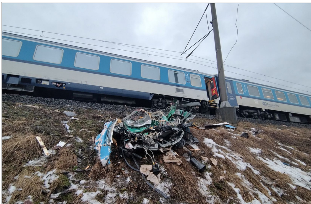
Obr. č. 12 Torza části předního čela a ovládacího pultu stanoviště strojvedoucího přední kabiny vytržené nehodovým dějem z lokomotivní skříně HDV se nacházel vpravo na svahu zemního tělesa náspu v sousedství 4. TDV vlaku Ex 546.
