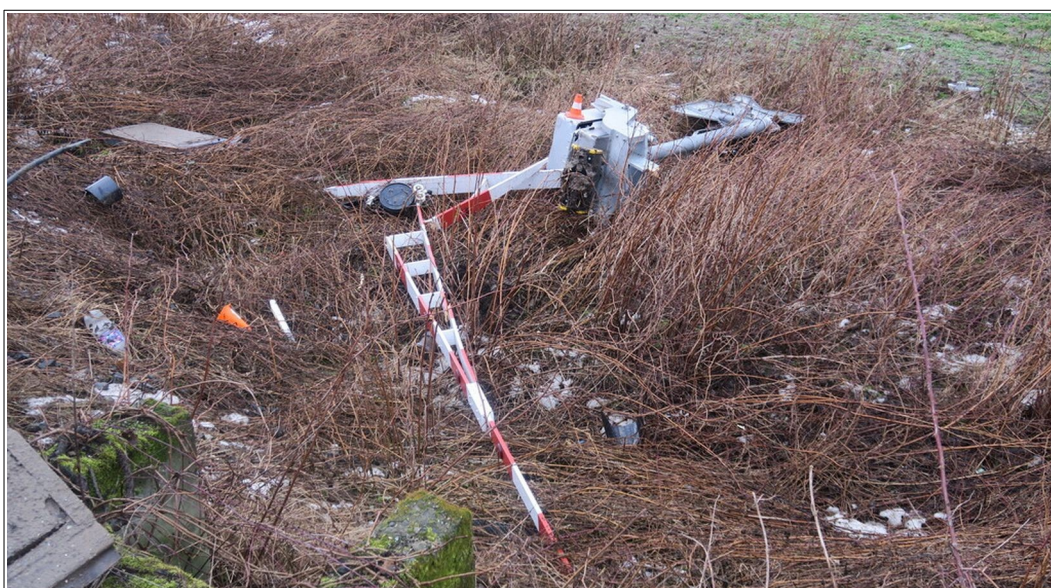
Obr. č. 18 Následkem nehodového děje zničený výstražník „A“ se nacházel i se zlomeným břevnem závory pod patou svahu zemního tělesa náspu vně TK č. 2. Zdroj: DI
