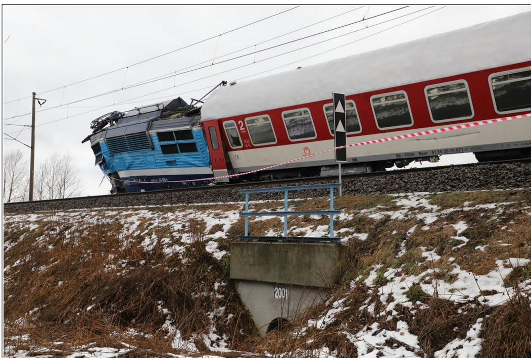
Obr. č. 11 Snímky dokumentující vykolejené 1. TDV a HDV vlaku Ex 546 v konečném postavení po MU
