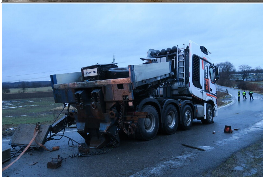
Obr. č. 13, 14 Tahač návěsů MB v konečném postavení po MU, tzn. také v místě, kde došlo následkem uváznutí podvalníku Goldhofer k zastavení přední části jízdní soupravy. Ze spodního snímku je dobře patrná přední návěsová část podvalníku, která i po MU zůstala spojená s točnicí tahače.
