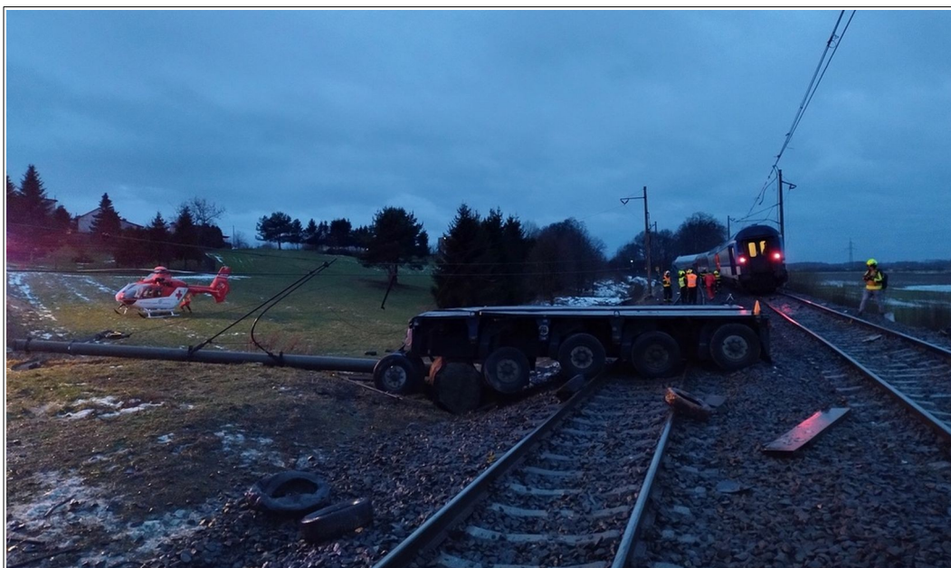
Obr. č. 17 Zadní část podvalníku Goldhofer v konečné poloze po MU nacházející se z větší části v TK č. 1 v prostoru kolejiště za ŽP P6512. Levá část snímku dokumentuje zničenou TP č. 41. Zdroj: DI
