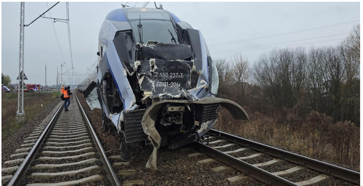
Zdjęcie 2 – Skutki zdarzenia w pojeździe kolejowym – uszkodzona kabina i czoło ED161- 004a (fot. komisja kolejowa)
