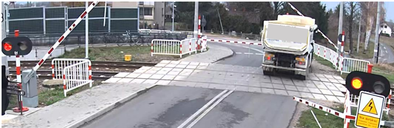
Zdjęcie 9 – Widok z kamery od strony napędu N1 - zatrzymanie się samochodu ciężarowego przed opuszczającą się rogatką zjazdową napędu N3 (źródło: PKP PLK S.A.).
