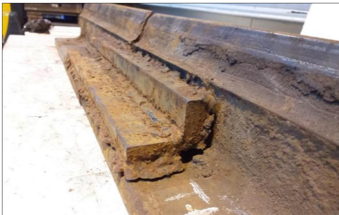
Figura 11 Vista del espaldín fracturado tras la reparación temporal mediante la soldadura en el alma y el patín de dos placas metálicas (Fuente CTV - ADIF)
