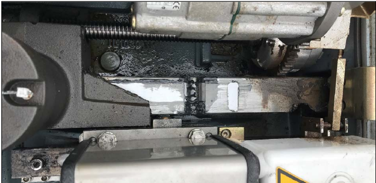
Abbildung 9: Gelöste Festhaltung der Schieberstange Weiche W1
