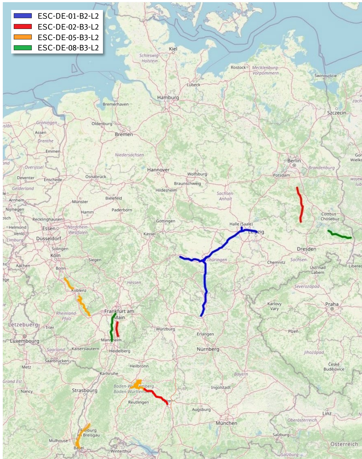
Abbildung 1: Strecken mit ETCS Level 2 Ausrüstung in Deutschland
