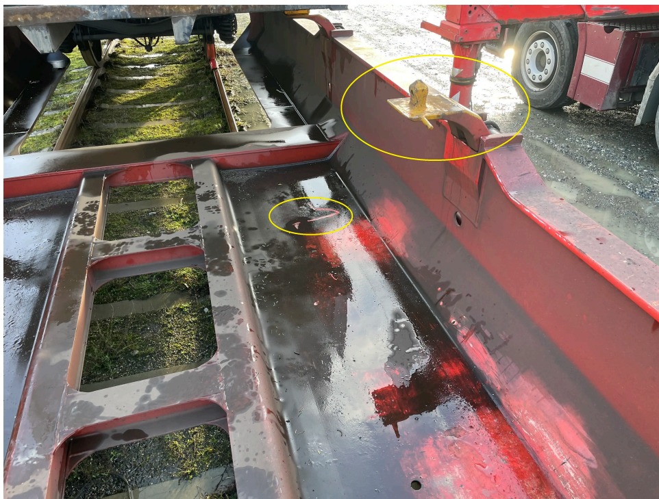
Figur 2. Containerbærevogn/lommevogn. De gule cirkler viser hhv. den containertap/bærebeslag som vekselladet faldt ned fra, og ridser i bunden af vognen, som vekselladets nederste forreste højre hjørne lavede.
