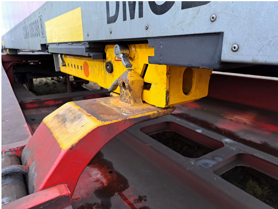
Foto 2. Vekselladets nederste forreste højre hjørne læsset ved siden af containerbæretap, men oven på bærepladen. Foto er taget ifm. jernbanevirksomhedens forsøg med fejllæsning d. 13-01-2025.
