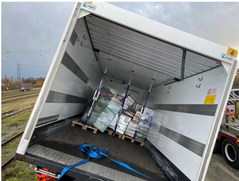
Foto 1. Det kæntrede veksellad læsset med drikkevarer i forreste halvdel.
