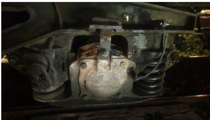
Foto nr.5 - Urme de solicitare termică la cutia de osie la roata nr.1
