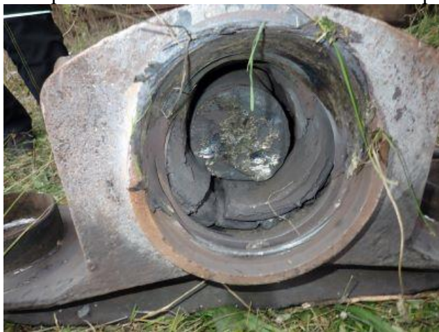
Foto nr.7 - Fus osie rupt în interiorul cutiei de osie
