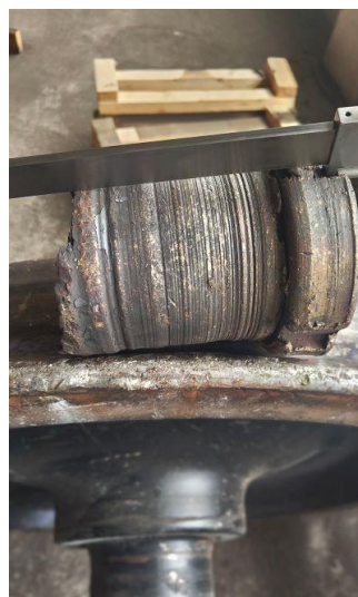
Foto nr.12 - Capăt fus de osie rupt
