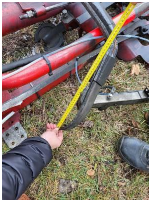
Foto nr.3 și nr.4 – cornul primei portperii a pantografului nr.1 partea stângă
