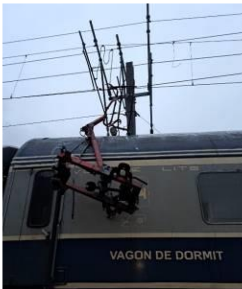
Foto nr.8 și nr.9 – pantograful locomotivei EA 583 după oprirea trenului în stația CFR Azuga - agățat în dreptul celui de-al 3-lea vagon din compunere
