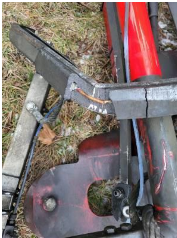
Foto nr.3 și nr.4 – cornul primei portperii a pantografului nr.1 partea stângă
