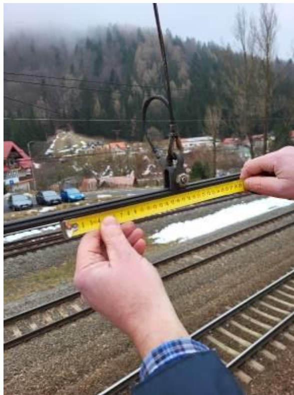
Foto nr.10 și nr.11 – prima urmă de frecare nouă pe firului de contact corespunzător liniei directe nr.II
