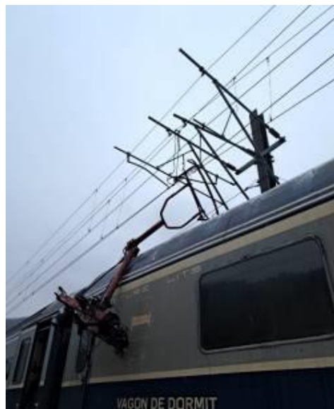
Foto nr.8 și nr.9 – pantograful locomotivei EA 583 după oprirea trenului în stația CFR Azuga - agățat în dreptul celui de-al 3-lea vagon din compunere
