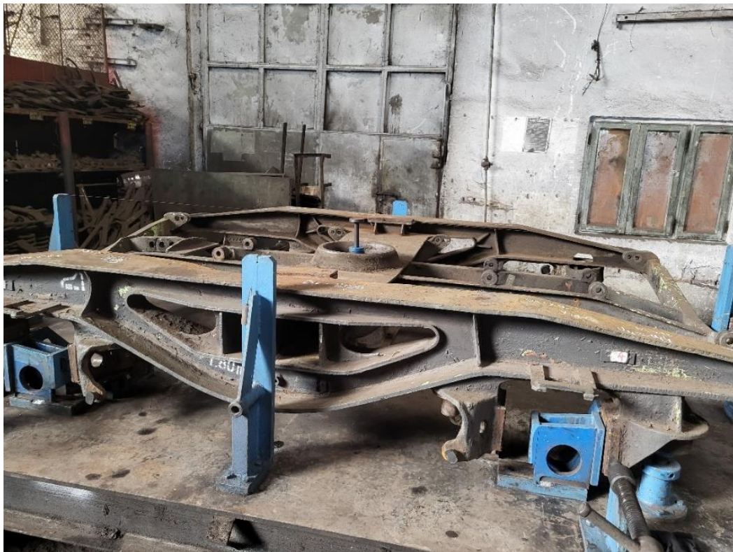
Foto nr.5 - cadrul de boghiu aferent boghiului cu roțile 1÷4 fixat pe standul de măsurare
