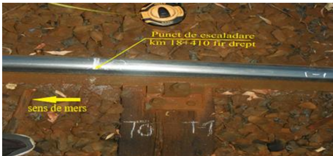
Foto nr.3: Punctul „0” - prima urmă de escaladare la km 18+410 (roata din partea dreaptă a osiei nr. 1)
