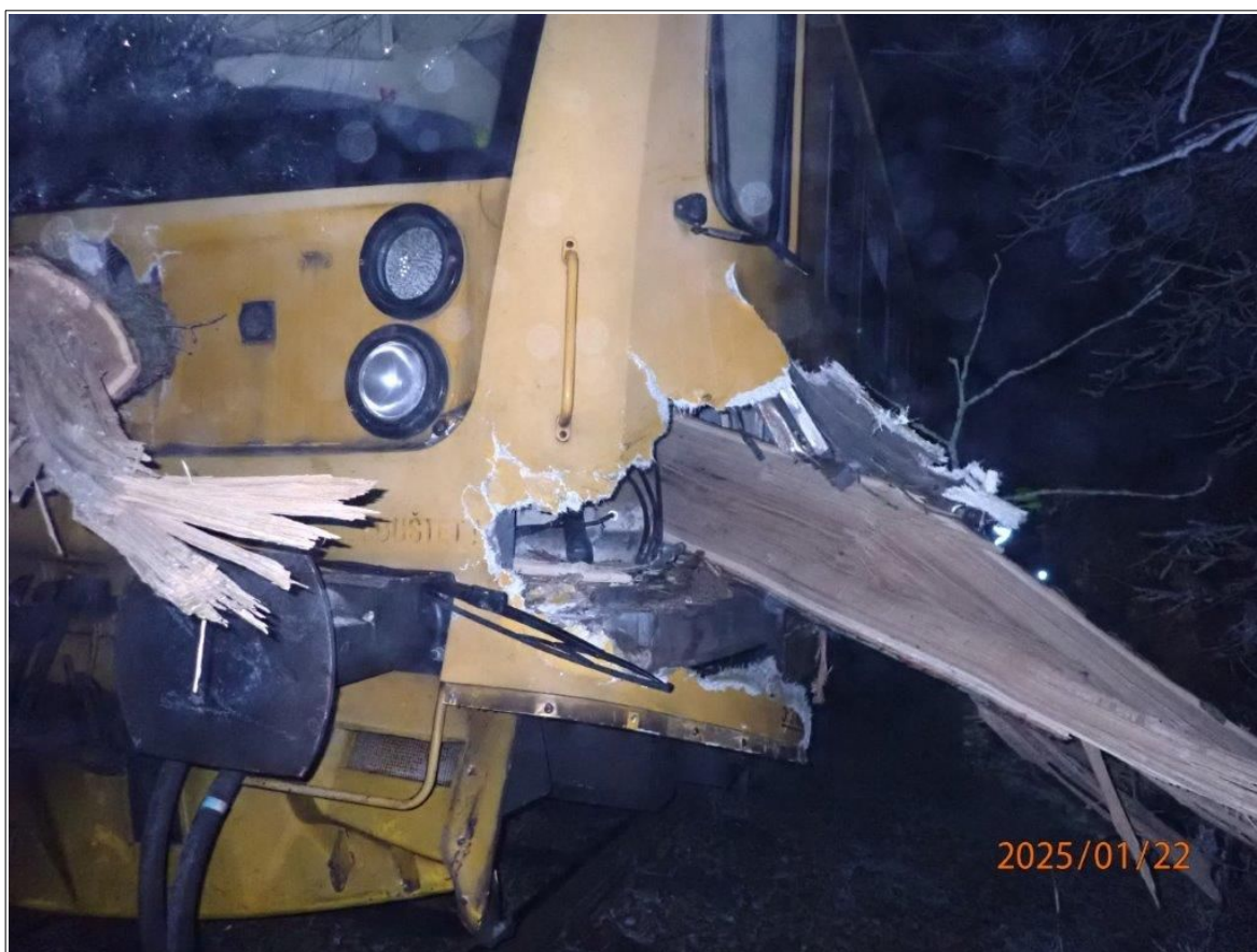
Obr. č. 8: Pohled na levou přední část ŘDV 914.199-5 vlaku Os 24836 po vzniku MU Zdroj: SŽ
