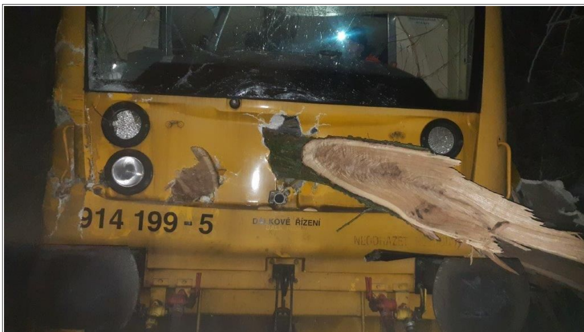
Obr. č. 7: Pohled na přední čelo ŘDV 914.199-5 vlaku Os 24836 v konečném postavení po MU Zdroj: SŽ
