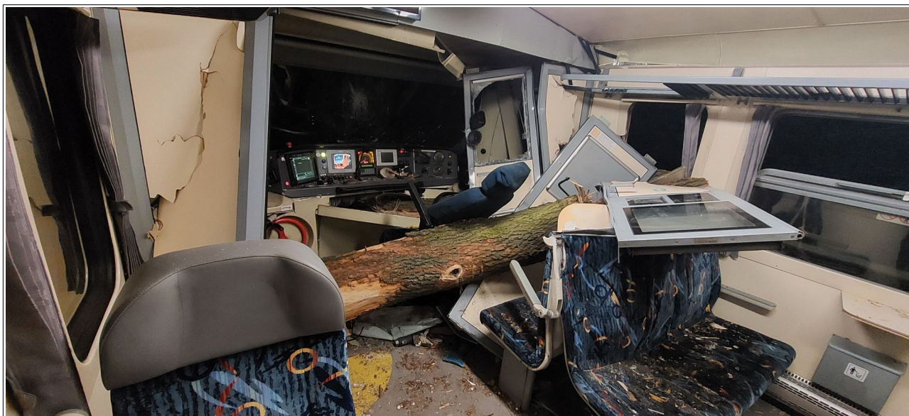
Obr. č. 9: Pohled na přední oddíl pro cestující, deformovanou zadní stěnu kabiny strojvedoucího a na kabinu strojvedoucího ŘDV 914.199-5 vlaku Os 24836 po vzniku MU Zdroj: ČD
