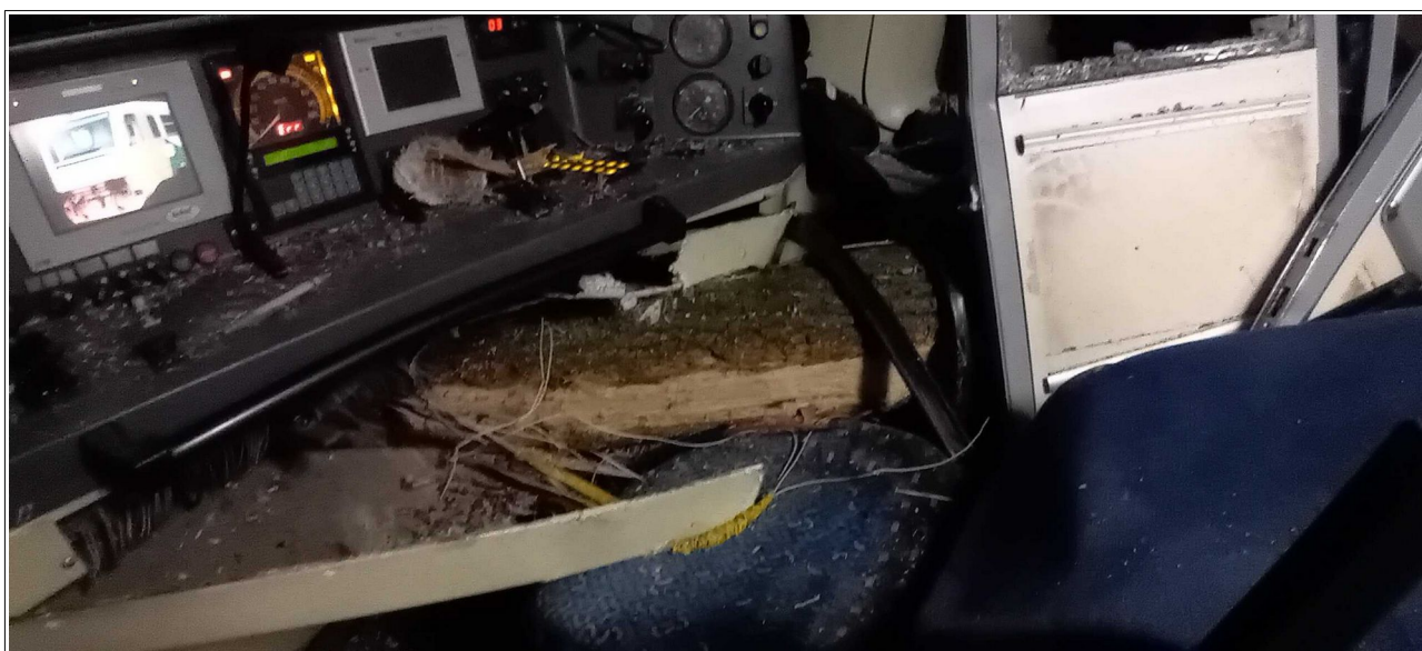
Obr. č. 10: Pohled na ovládací pult stanoviště strojvedoucího ŘDV 914.199-5 vlaku Os 24836 po vzniku MU Zdroj: ČD
