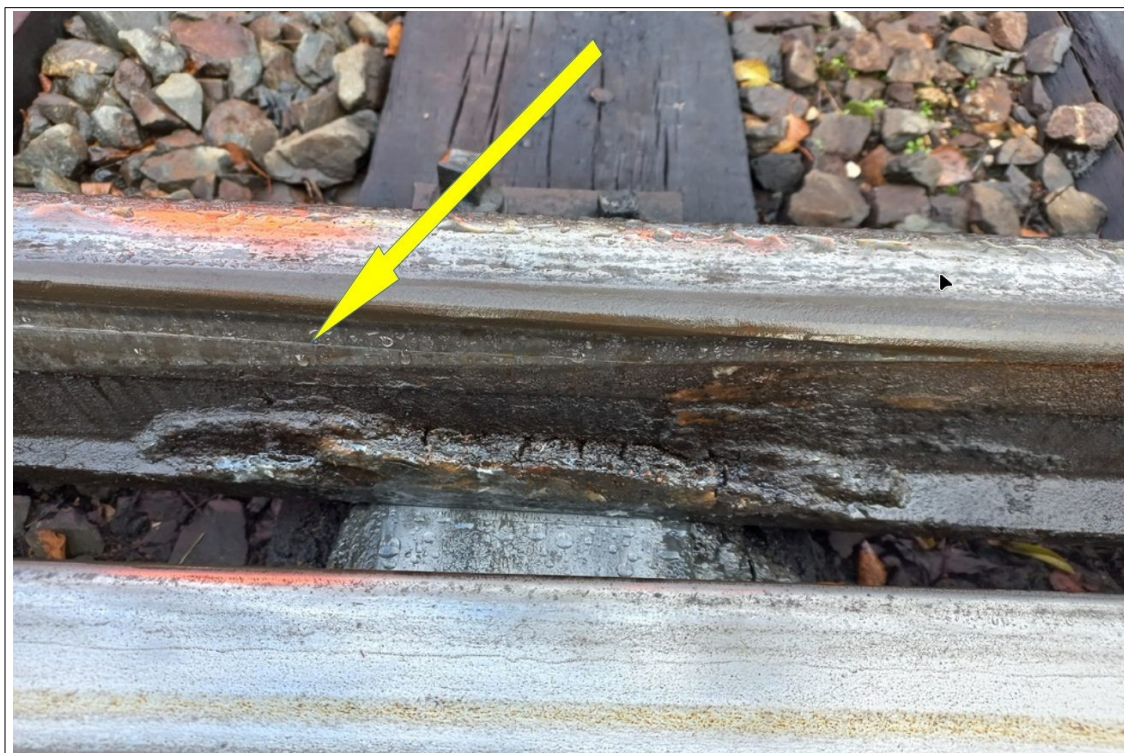
Obr. č. 3: Pohled na stopy po rozřezu na vnitřní straně jazyka výhybky č. 24
