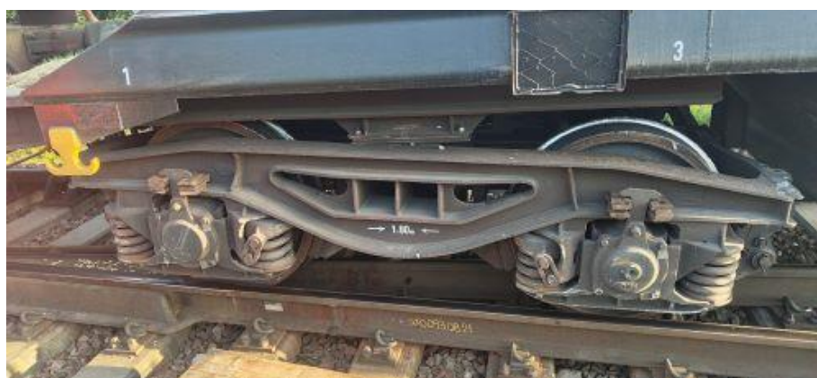
Foto nr.1 și 2 - boghiul deraiat oprit în inima macazului nr.16
