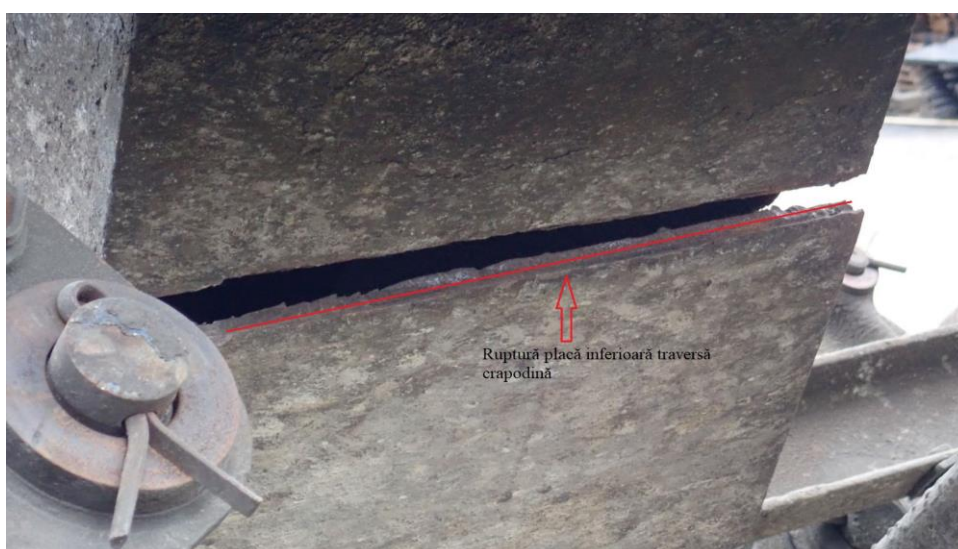
Foto nr.7 – Placă inferioară transversă crapodină ruptă pe toată lățimea
