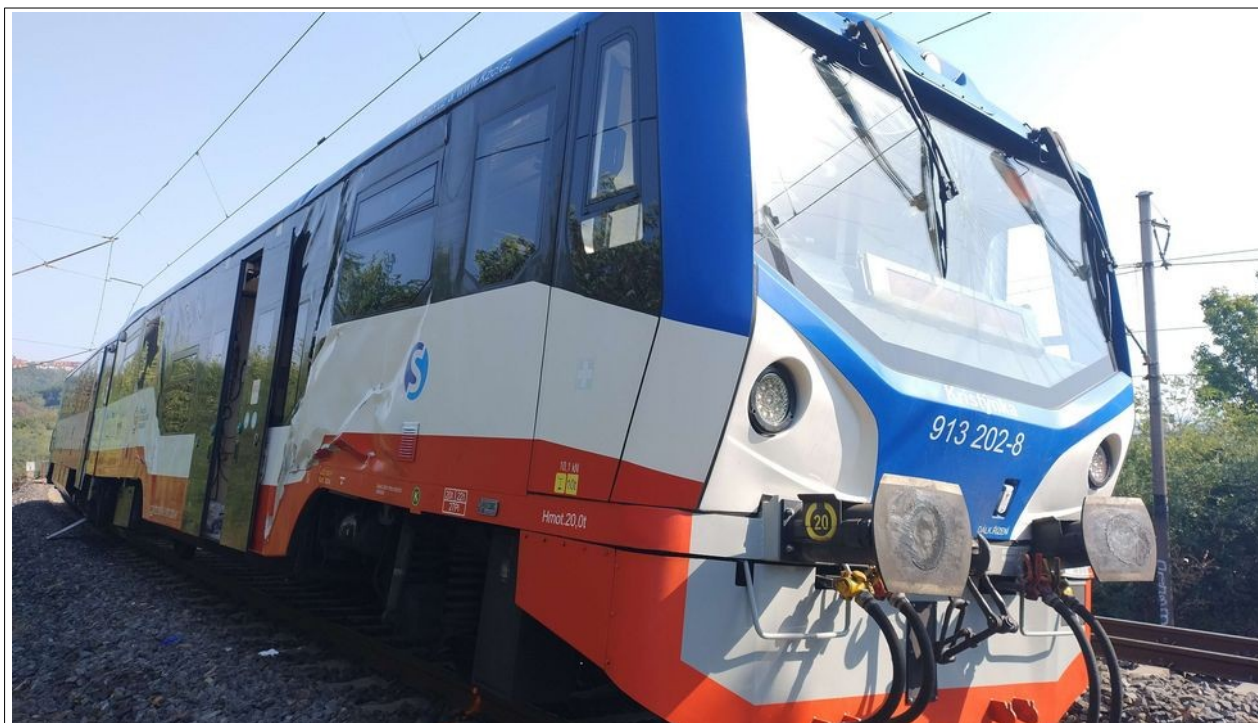
Obr. č. 3: Následky srážky – deformace boku skříně RV 913 202-8 a uchycení nárazníků
