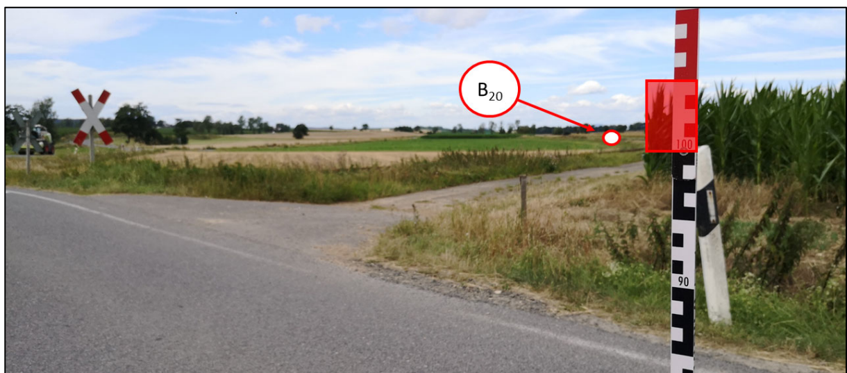
Abbildung 7: Sichtfläche im Q IV für 20 km/h Räumgeschwindigkeit
