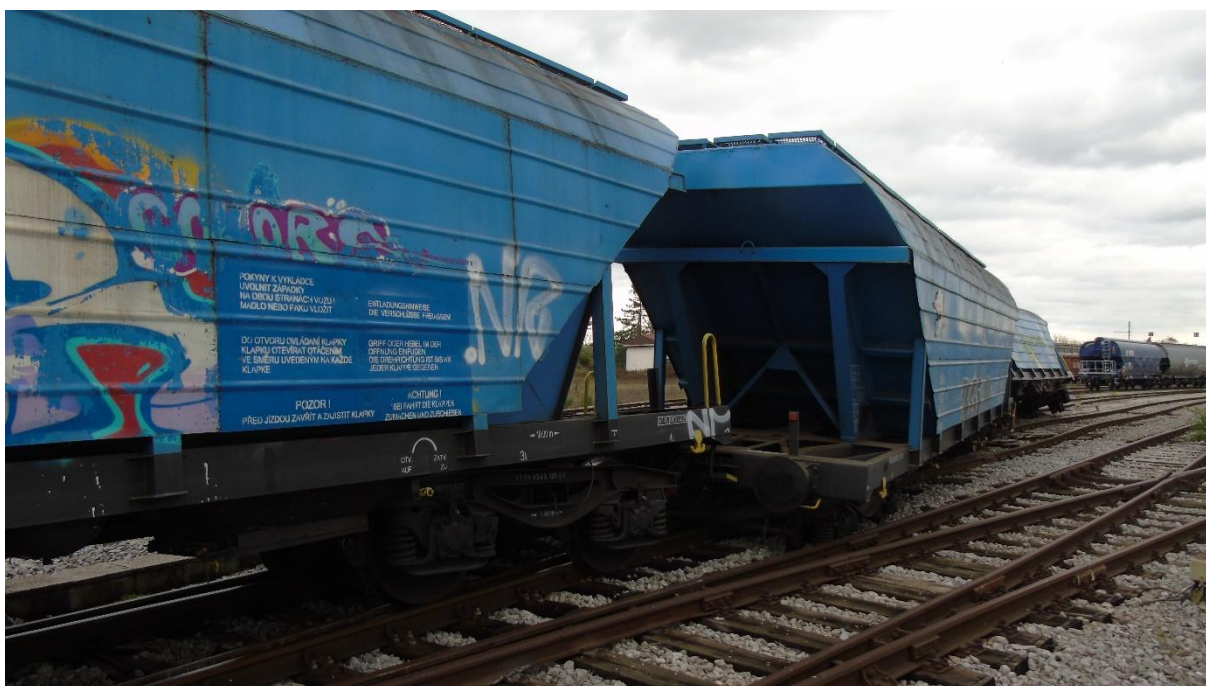
Slika 4. – Opći snimak iskliznuća, kolodvor Zagreb RK kolosijek S-15 (Izvor slike: AIN)
