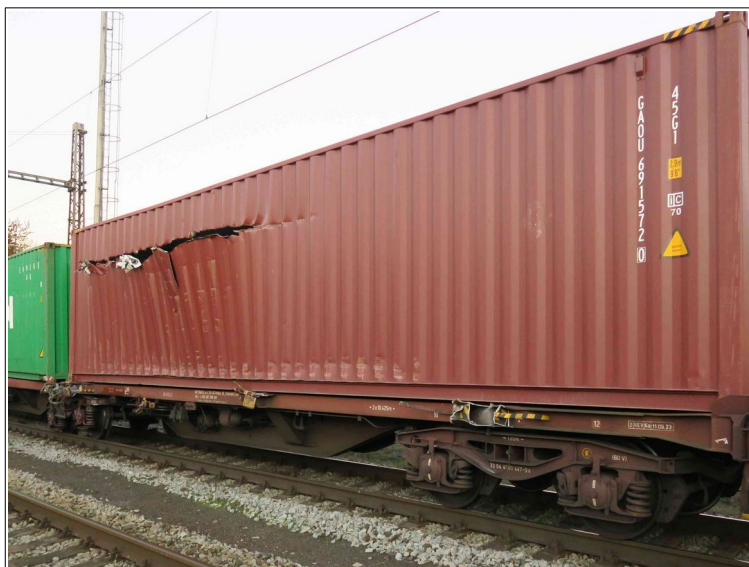
Obr. č. 3: Poškození kontejneru vlaku Nex 61020
