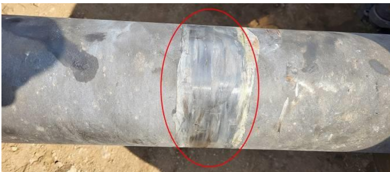
Foto nr.5 - corpul osiei cu roțile nr.1-2 cu urme de frecare în zona centrală
