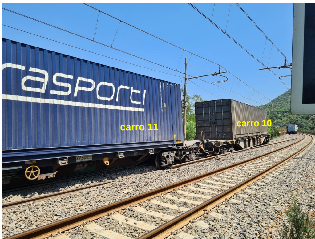
Figura 13 - Particolare del treno n. 64995 dopo lo svio e la rimozione dei carri non sviati (nn. 14, 15, 16 in coda, e nn. 1, 2, 3, 4, 5, 6, 7, oltre al locomotore, in testa) - (fonte: Ufficio).
