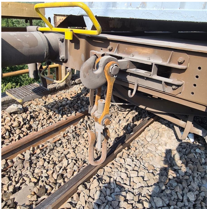
Figura 15 - Treno merci n. 64995: organi di attacco posteriori (smt) del carro n. 9 (fonte: Ufficio).
