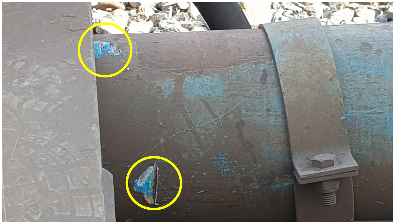
Figura 30 – Incisioni sulla barra di collegamento fra i due moduli del carro n.8 (fonte: Ufficio).
