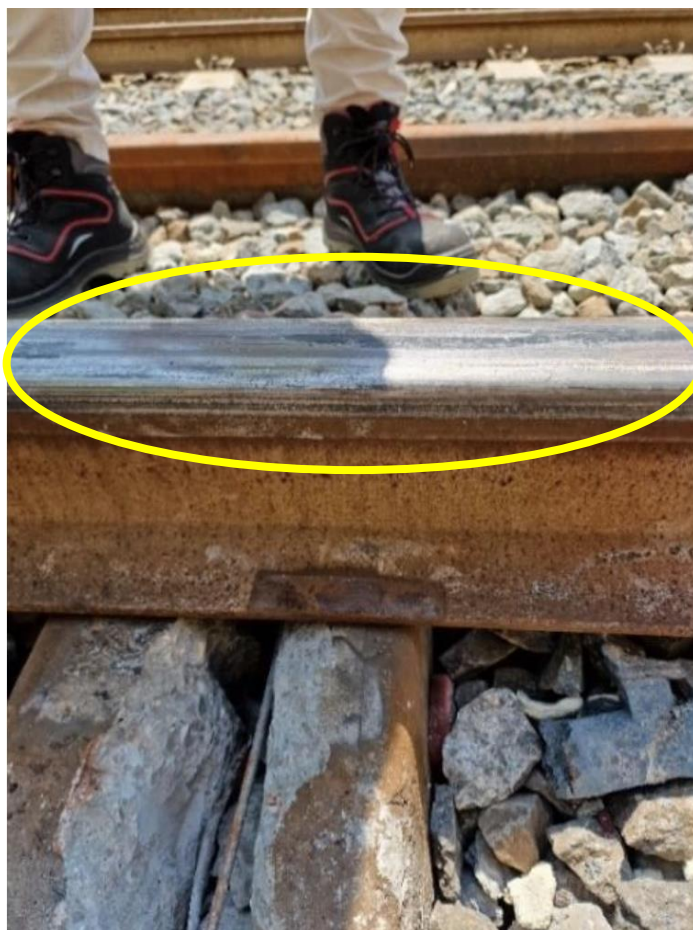
Figura 18 - Primo punto di svio (fonte: RFI elaborazione Ufficio).
