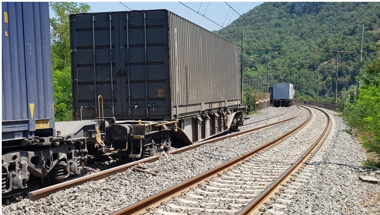
Figura 4 – Spezzamento del treno n. 64995 dopo lo svio ( fonte: Ufficio ).
