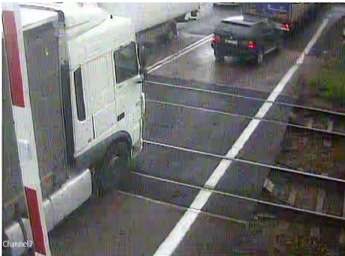
Zdjęcie 1 – Widok samochodu ciężarowego, który zatrzymał się w strefie przejazdu za stojącymi za przejazdem samochodami (źródło: PKP PLK S.A.)
