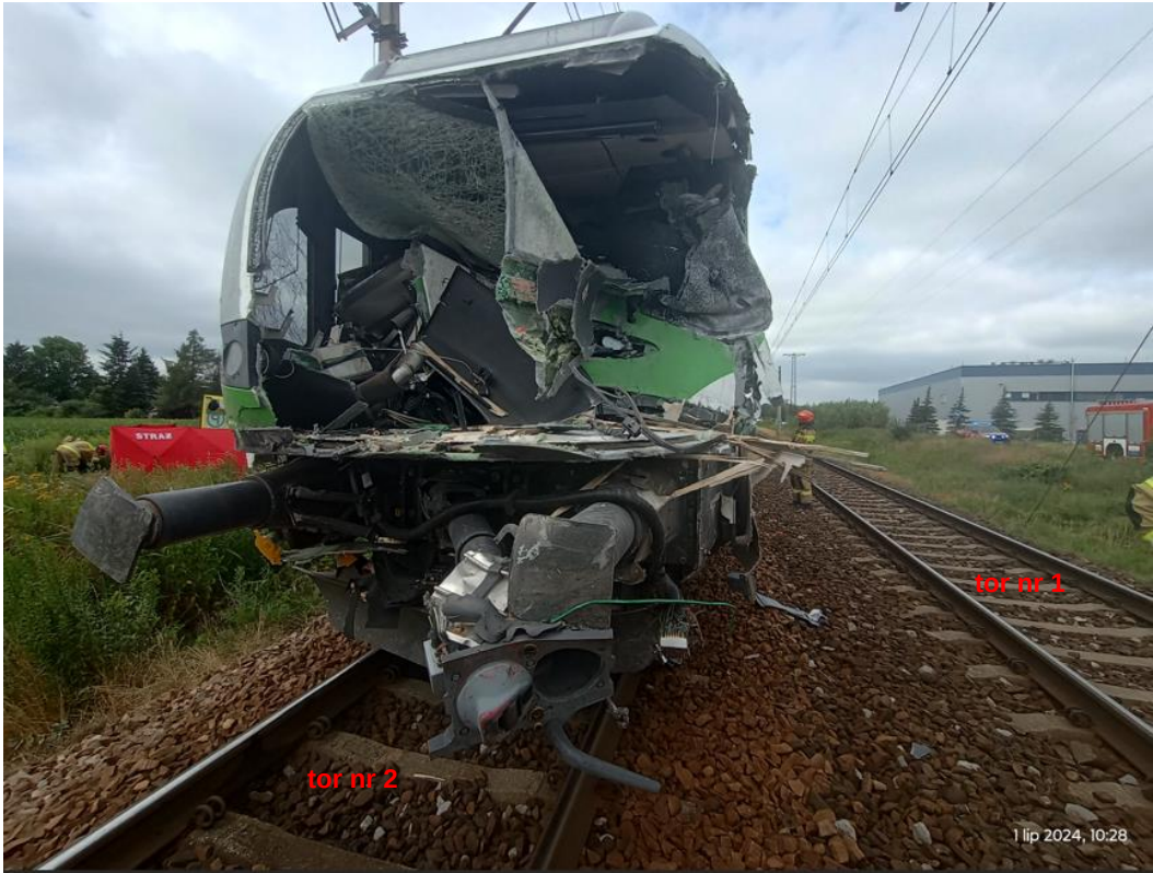
Zdjęcie 6 - Widok zniszczonej ściany czołowej pojazdu kolejowego ER75-001 (źródło: KM)
