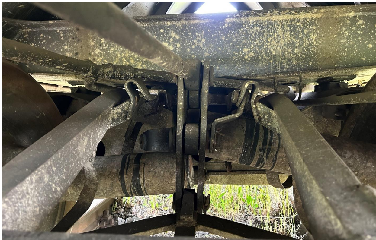
Zdjęcie 3 - Widok złamanej osi (źródło: materiał własny PKBWK)
