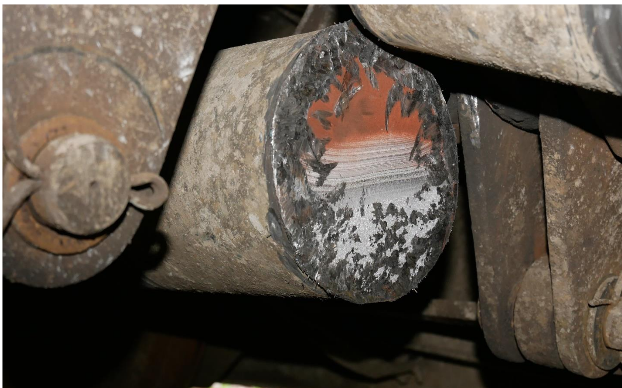
Zdjęcie 4 - Widok złamanej osi (źródło: materiał własny PKBWK)
